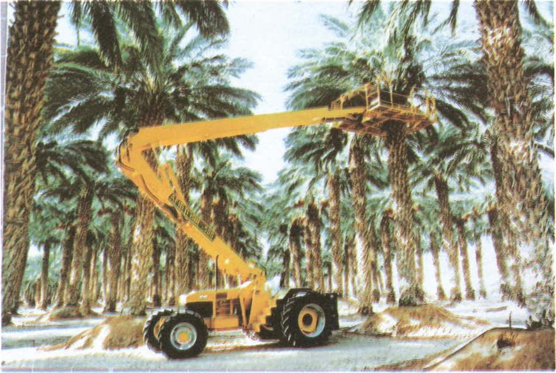
الشكل (٨٣): جنى التمور بواسطة السلم الميكانيكى (إسرائيل)
