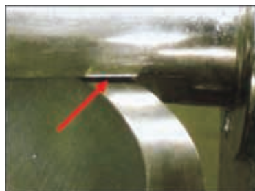
图 399 转盘与刀轴之间的空隙
