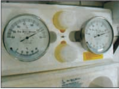
图 427 配有两个水活度仪的成套装置可以同时测定两个样品
