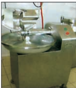
图25 20L的小型斩拌机，由单相电动机驱动
