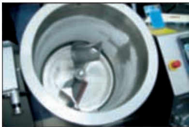
图 48 装有冷却双夹套和真空泵/发动机装置的翻转器
