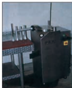
图 33 带有不同尺寸注液漏斗的活塞式灌肠机 (20L)
