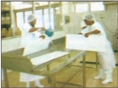
图 488 用刷子手工清洗工作台
