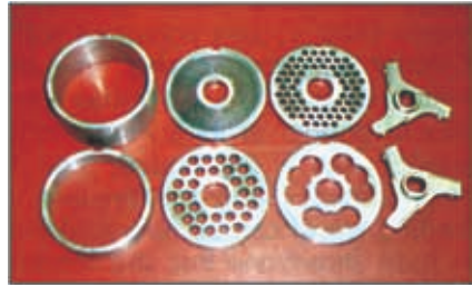
图 21 不同孔径的绞板、星形刀和拧紧切割装置的限位环
