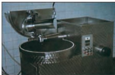
图 29 盘式斩拌机与绞肉机的组合装置（双式），带有盘式斩拌机（60L）和绞肉机（进料孔径 114mm）
