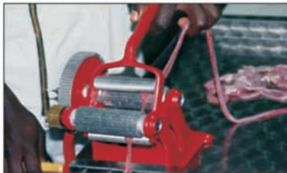
步骤 3. 使用小型手动肠衣清洗机让组织层变松弛
