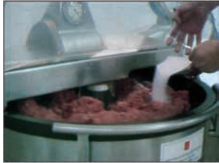
图 62 在制作混合肉料初始阶段加入腌制用亚硝酸盐
