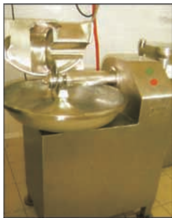
图 312 单相电力驱动的转盘斩拌机（18L）
