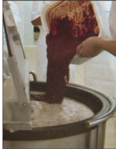
图 191 添加冷冻肝糊 将肝糊加入转盘斩拌机中的热预煮和热斩拌肉料中。转盘斩拌机保持低速旋转
