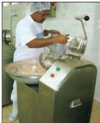
图 59 盘式斩拌机斩拌肉混合物，完成斩拌后将盖子打开，能够看到刀具
