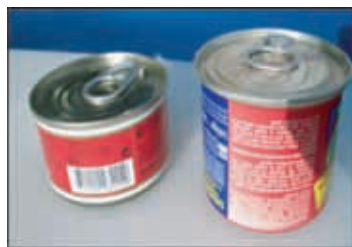
图 371 两片罐 左边是钢罐，右边是铝罐。钢罐为 浅冲罐，铝罐为深冲罐
