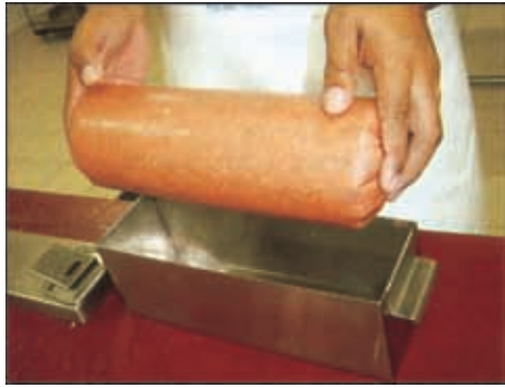
图 227 蒸煮前将肉块填塞到肠衣并放入模具中
