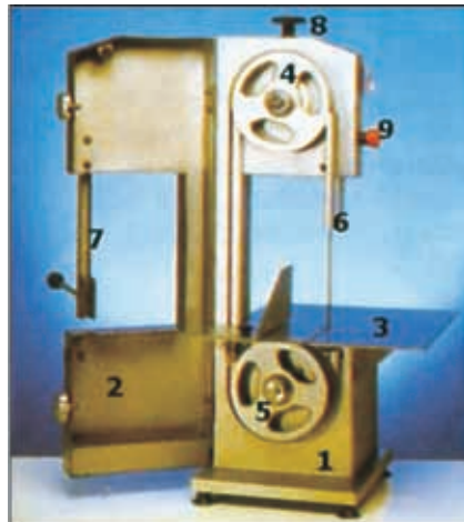
图 404 正在工作的带锯机 4. 可调节的张力轮；5. 驱动轮（与马达相连）；6. 锯条导向装置；8. 张力把手；9. 应急开关
