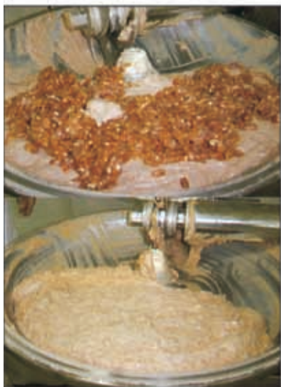
第2步：将粗纹材料添加到细斩拌肉糊中(上方)。在转盘斩拌机内斩拌几圈后的最终混合料(下方)
