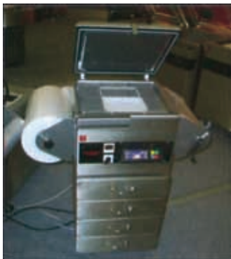
图 356 用软质盖膜封塑料盘的 简易手动机（封盘机）
