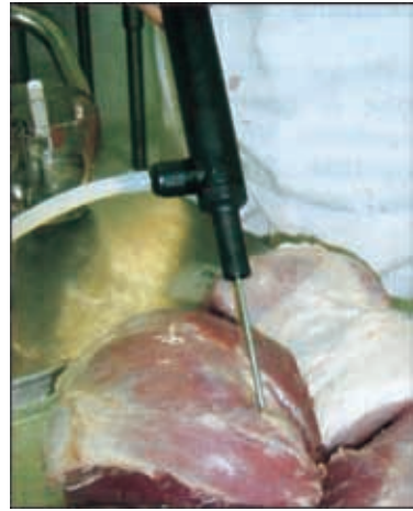
图 67 应用手动腌制泵进行盐水注射
