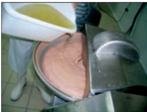
图100 向正在腌制和绞碎的肉糊中添加植物油
