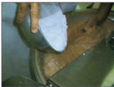
图 91 在盘式斩拌机中添加填充剂/淀粉（干）
