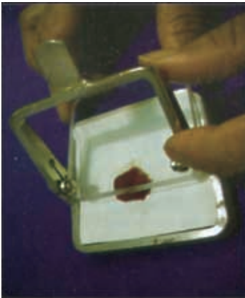
图 429 通过压缩肉类样品的方式测定持水性
