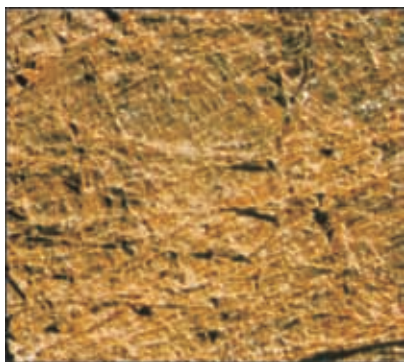
图 485 木制切菜板 当切菜板变湿和埋置了细菌时，刀痕被塞封起来（卫生学上是不可接受的）
