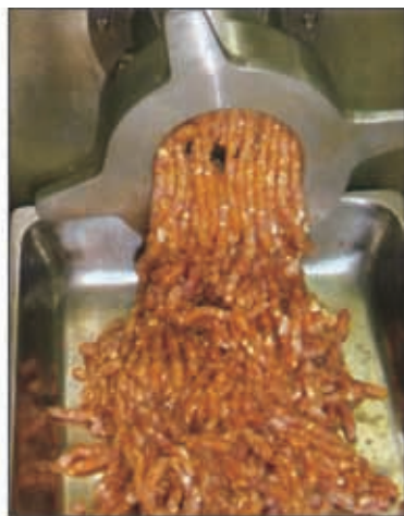
第1步：将绞碎肉添加到制作粗纹馅香肠的细斩拌肉糊中
