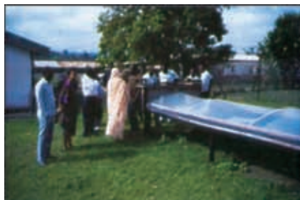
图 291 一个简易的太阳能接收器 上面的覆盖物是透明的塑料膜
