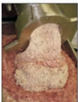
第三步:通过孔径为 3mm 的刀盘来绞碎混合料
