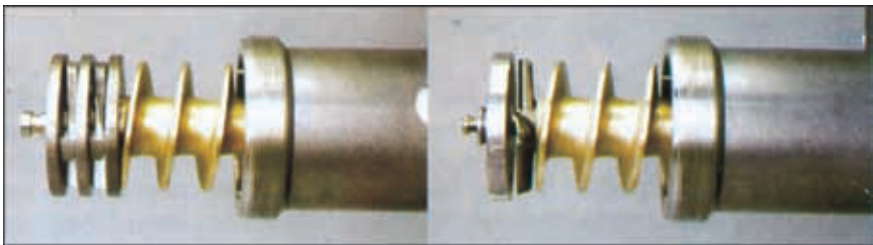
图 393 绞肉机中的切割器，被组装在了给料螺旋上（螺旋钻） 左. UNGER 型，五刀切割器；右. ENTERPRISE 型，二刀切割器
