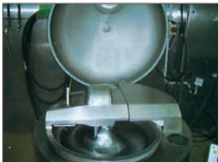
图 30 真空斩拌机；为了对转盘中的肉馅进行真空处理，需要用盖子将转盘密封起来
