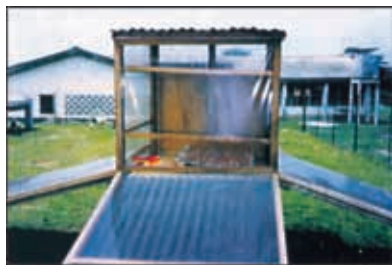
图 296 多太阳接收器的干燥室干燥室的前方和两测是透明的，以接收更多的太阳能。从接收器到干燥室有一个进气口
