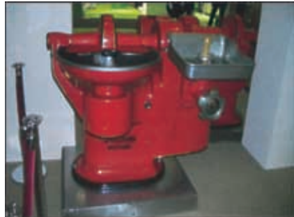
图 480 刷有红漆的老式肉类加工设备 (应该采用不锈钢材料)
