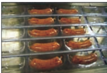
图 350 半自动真空包装机 将香肠放到模塑底膜中。抽成真空口，将顶膜封到底膜上。每份产品都可以被切分开（参见图 352）
