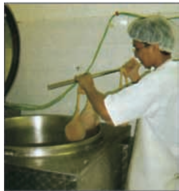
图 116 腌制的熟火腿 通过浸入蒸煮锅内的热水里蒸煮
