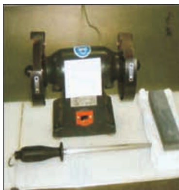
图 389 带有砂纸页轮的磨刀机 右边轮用来磨削，左边轮用来磨刀 磨刀机右侧为湿的磨刀石 磨刀机 前下方为抛光钢
