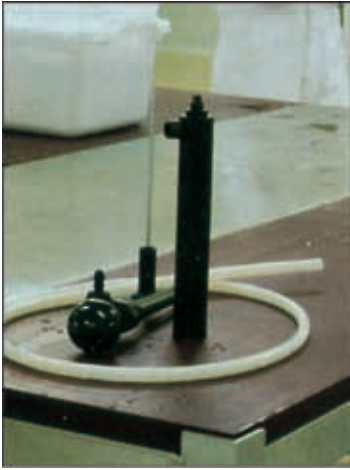
图 93 以水溶液形式注射添加剂的应用；泵和盐水注射针（亦见图 226）
