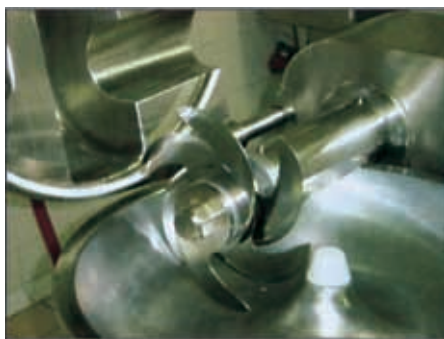
图26 装有6把弯刀的斩拌机
