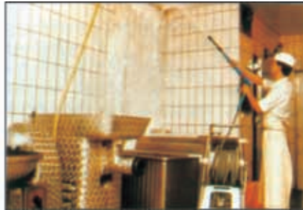
图 489 用加压水清洗墙壁，要当心，不要使设备受到污染
