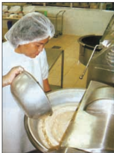
图95 牛乳蛋白质/水/动物脂肪乳剂的制备
