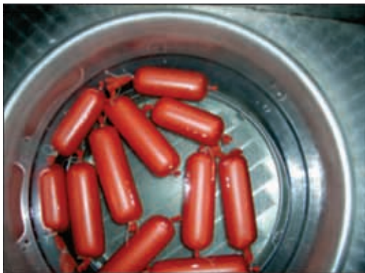
图 115 在蒸煮锅的热水中处理大口径香肠
