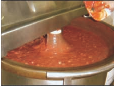
图 190 将生鲜肝脏进行预斩拌（含有腌制用盐） 这种肉糊晚些时候将加入预煮过的肉料中（见图 191）
