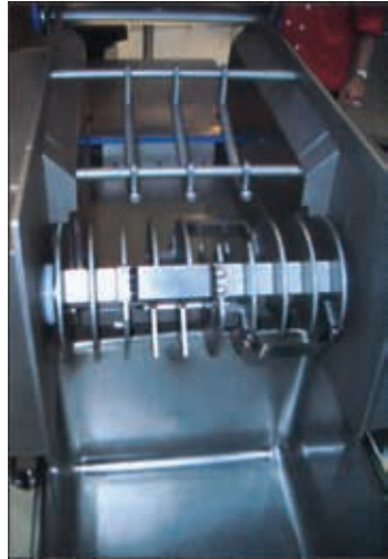
图 57 带有旋转圆刀的冻肉切块机，用于将速冻肉块切割成小块/薄片
