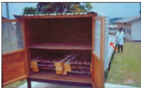
图 294 连接到隧道式干燥器的太阳能接收器上的木制干燥室 干燥室金属网盘上放着正在干燥中的肉品。
