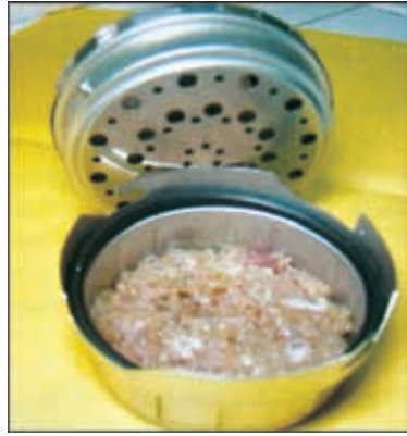
图 428 盛有受测样品的水活度仪，装有内置湿度计的盖子（必须固定在盖子上）
