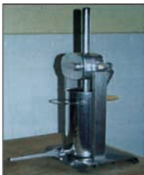
图 32 手动活塞式灌肠机 (10L)
