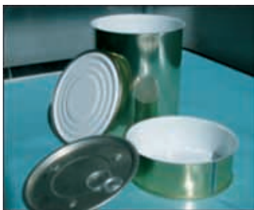
图 370 不同式样的三片钢罐 内衬为合成化合物，感应焊接的外壁， 配有易开环的盖子
