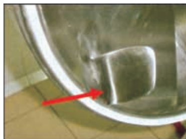
图 400 转盘盖上的叶板为清洗的关键区
