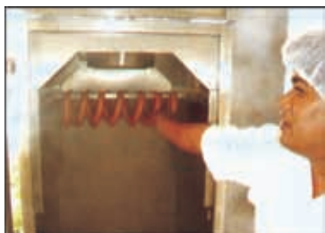
图 174 将所有香肠都排在杆子上以让烟在每根香肠周围循环
