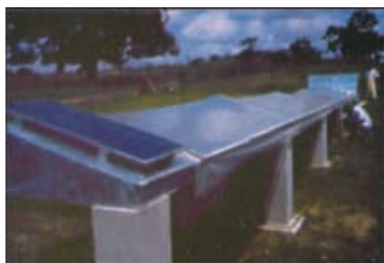
图 293 高成本的隧道式干燥器 采用屋顶式太阳能接收器。顶部为金属框架，底部为镀聚氨酯金属板。长度为 15m（表 13，类型 2）
