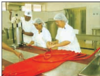
图 327 用红色纤维素肠衣制作的香肠 (cal. 22)，红色纤维素肠衣可将颜色转移到香肠表面
