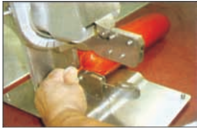
图 173 利用金属夹子将香肠末端封住
