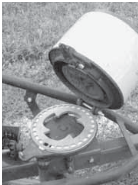
Lámina 101 Sistema cerrado de tolva para facilitar el cambio de plato.
