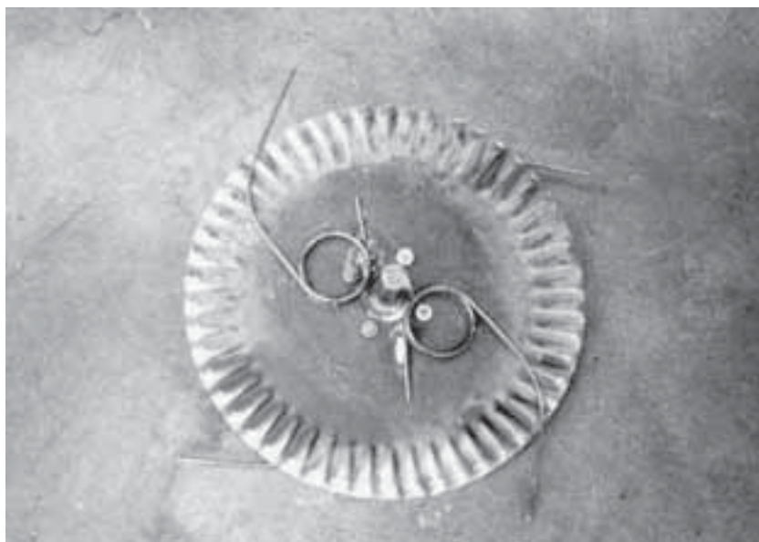
Lámina 76 Aparato para golpear diseñado para la autolimpieza de los dientes fijos.
