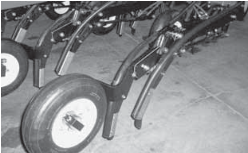
Lámina 13 Par de abresurcos de cincel con deflector horizontal. El cincel delantero aplica el fertilizante mientras que el cincel trasero aplica las semillas fuera de la línea del fertilizante y algo más superficiales.
