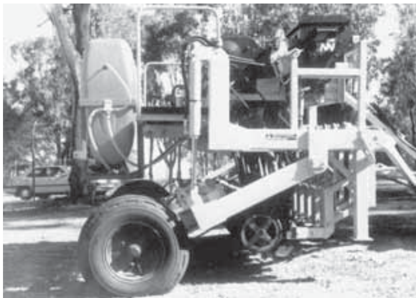
Lámina 132 Ejemplo de una sembradora universal para parcelas.
