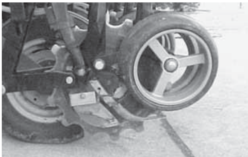
Lámina 79 Raspadores subterráneos en la versión de disco de un abresurco para labranza cero.
