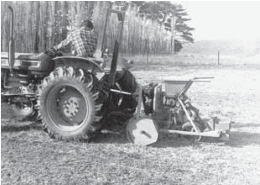
Lámina 129 Sembradora de un solo surco para labranza cero disponible en el comercio.
