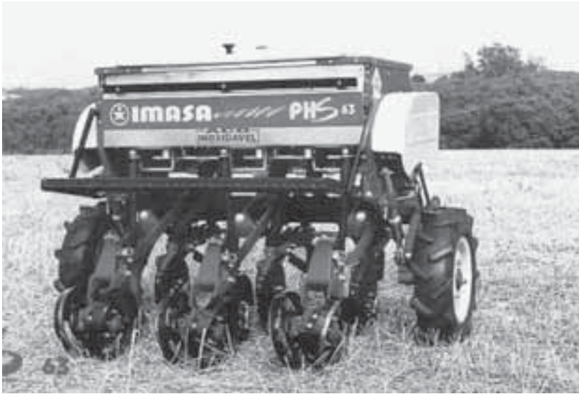
Lámina 104 Pequeña sembradora para labranza cero tirada por tractor.
