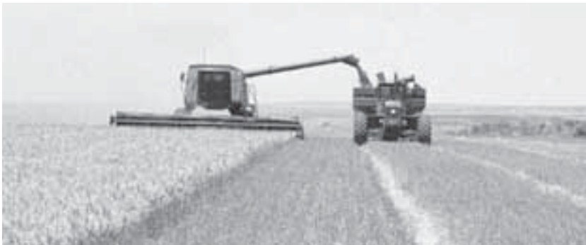
Lámina 118 Ejemplo de un sistema australiano de módulo primario de 9 m y de una trocha primaria de 3 m de ancho (Webb et al. , 2000).
