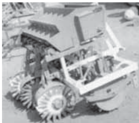
Lámina 110 Sembradora a golpe rotatoria para múltiples surcos.
