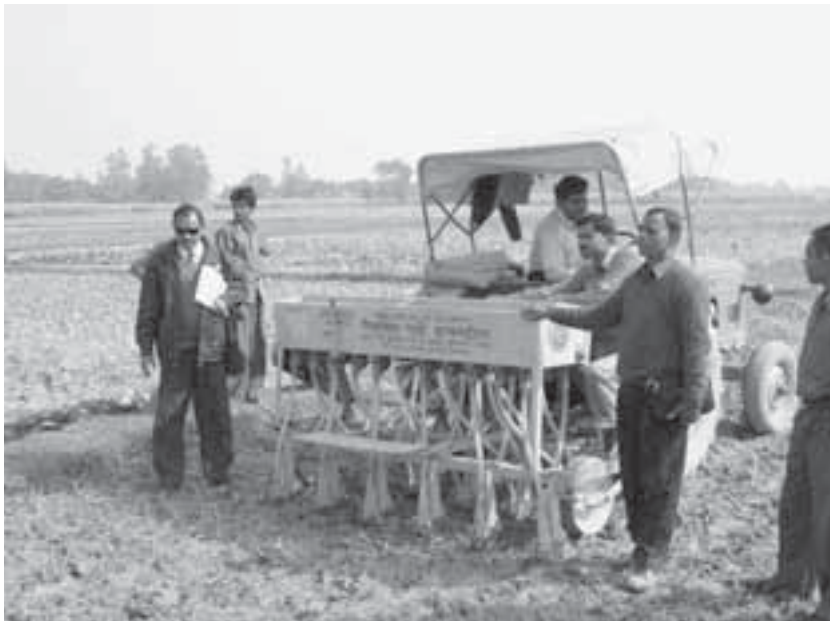
Lámina 108 Sembradora típica para labranza cero sobre un tractor hindú.
