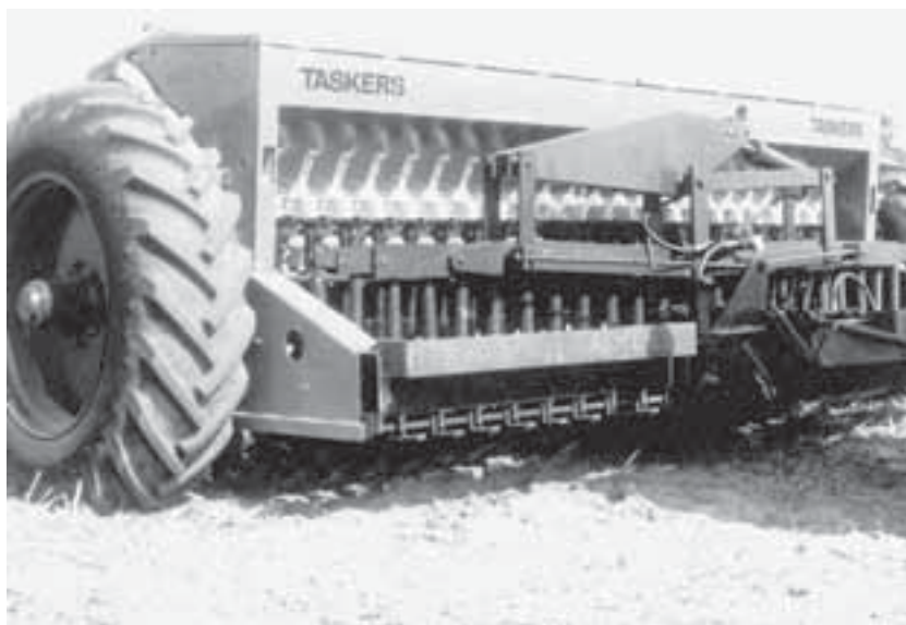
Lámina 50 Sembradora para labranza cero con un arreglo para «igualar» los resortes.
