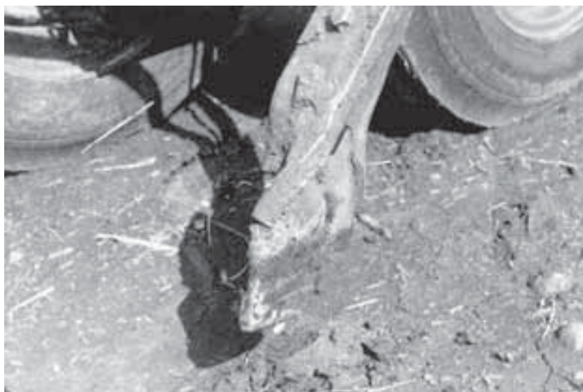
Lámina 11 Abresurco de tipo azada con punta roma para labranza cero (de Baker et al. , 1996).
