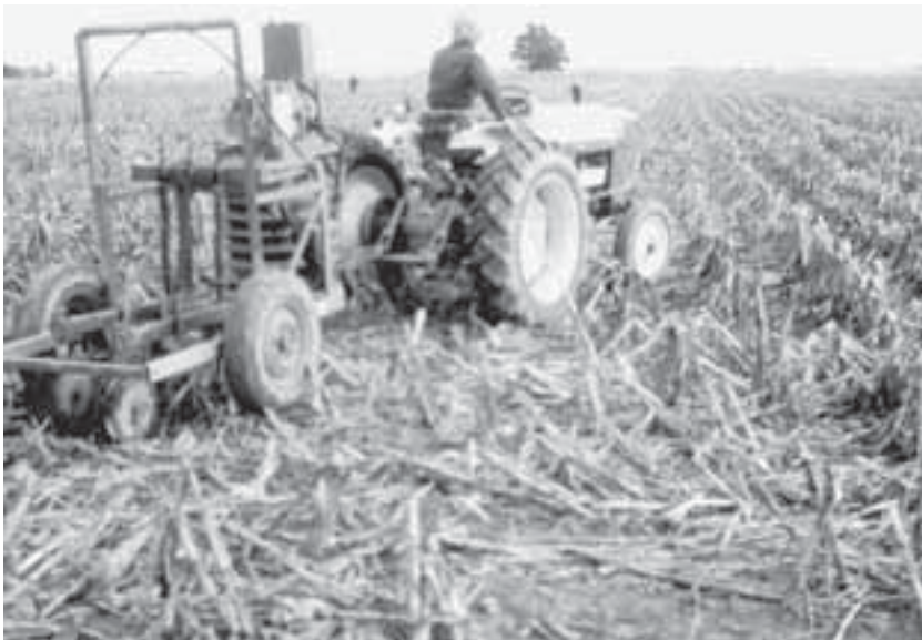
Lámina 131 Máquina de un solo surco para probar la capacidad de manejo de los residuos de un abresurcos para labranza cero.
