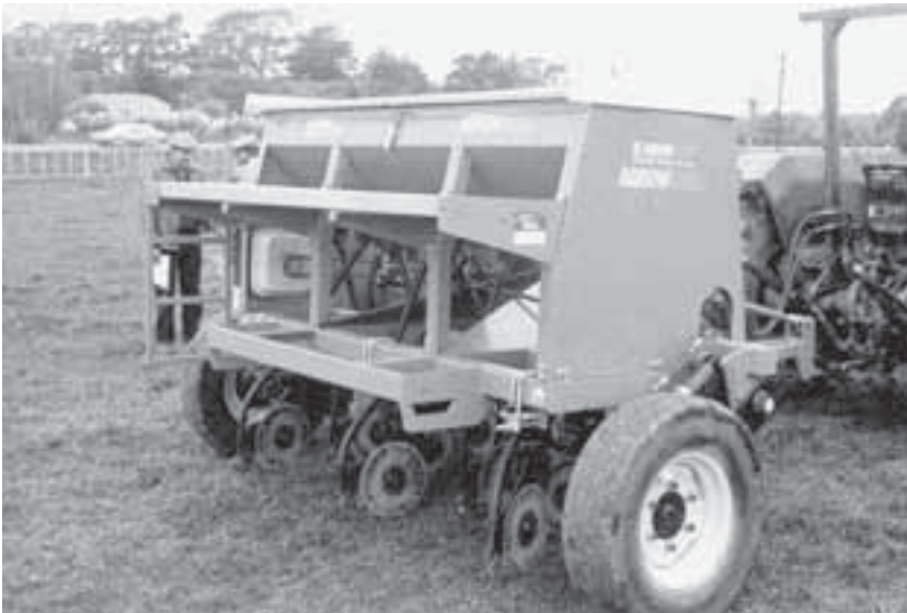
Lámina 94 Una sembradora para labranza cero con tolvas elevadas para los productos.
