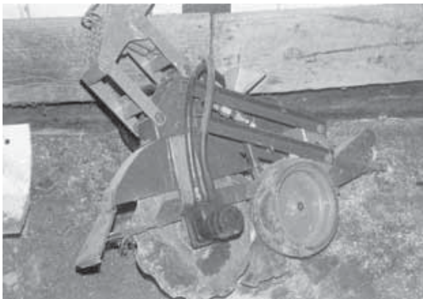
Lámina 73 Abresurcos de disco movido por toma de fuerza diseñado para girar más rápido que la velocidad de avance en el suelo.
