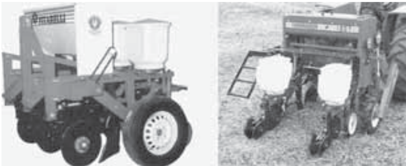
Lámina 105 Dos pequeñas sembradoras de precisión con tolvas para la fertilización y la siembra de precisión.
