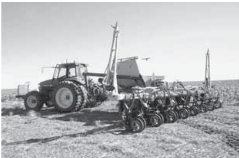
Lámina 90 Barra portaherramientas rígida de 4 m que se levanta para su transporte.
