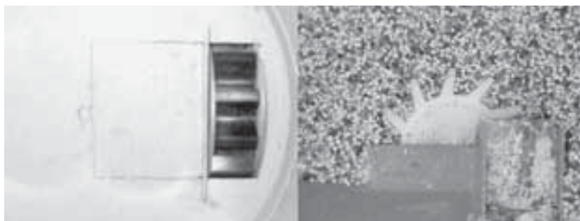
Lámina 102 Dos ejemplos de aparatos dosificadores del fertilizante usados en las sembradoras de precisión para labranza cero. A la izquierda: celda con muescas, a la derecha, rueda en estrella.
