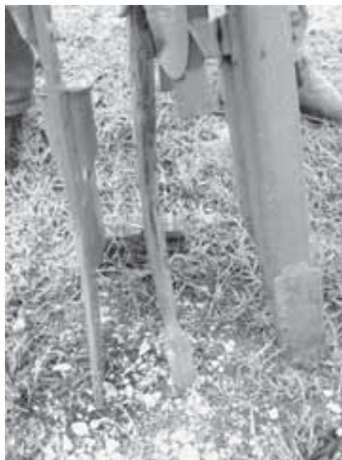
Lámina 99 Distintos abresurcos de dientes usados en sembradoras de precisión para tracción animal y labranza cero. El abresurco central tiene un surco en su borde delantero por el cual pasa el disco delantero.
