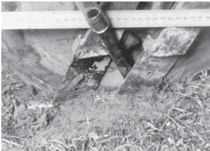
Lámina 59 Prototipo de abresurco de ala con láminas cortas y largas para la separación vertical de la semilla y el fertilizante (de Baker y Afzal, 1986).
