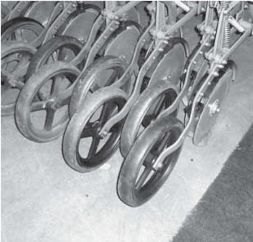
Lámina 2 Típico disco excéntrico para abresurcos para labranza cero que forma surcos verticales en V.
