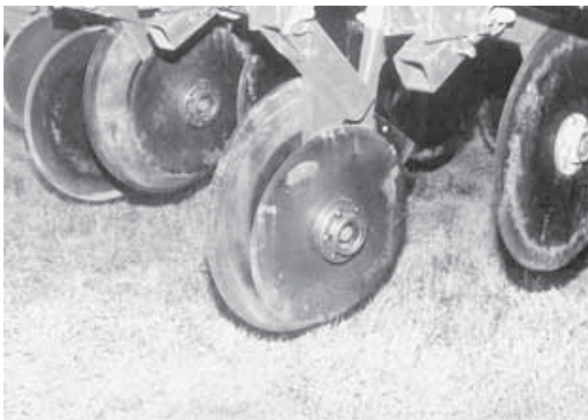
Lámina 3 Típico doble disco de distinto tamaño para abresurcos para labranza cero que forma surcos verticales en V.
