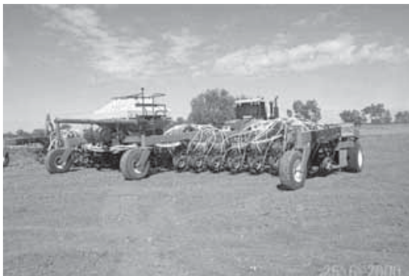
Lámina 91 Barra portaherramientas de 18 m que se remolca desde su parte trasera para el transporte.
