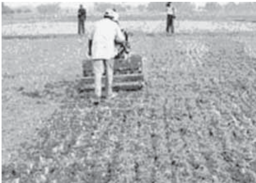
Lámina 114 Máquina de dos ruedas para labranza reducida en trabajo de labranza en fajas.
