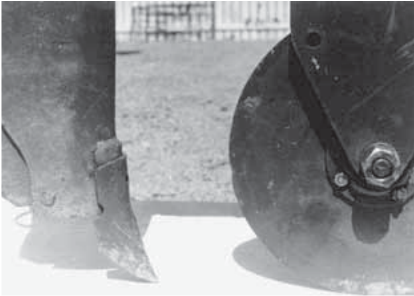
Lámina 12 Abresurco de tipo azada con punta aguda para labranza cero (de Baker et al. , 1976b).
