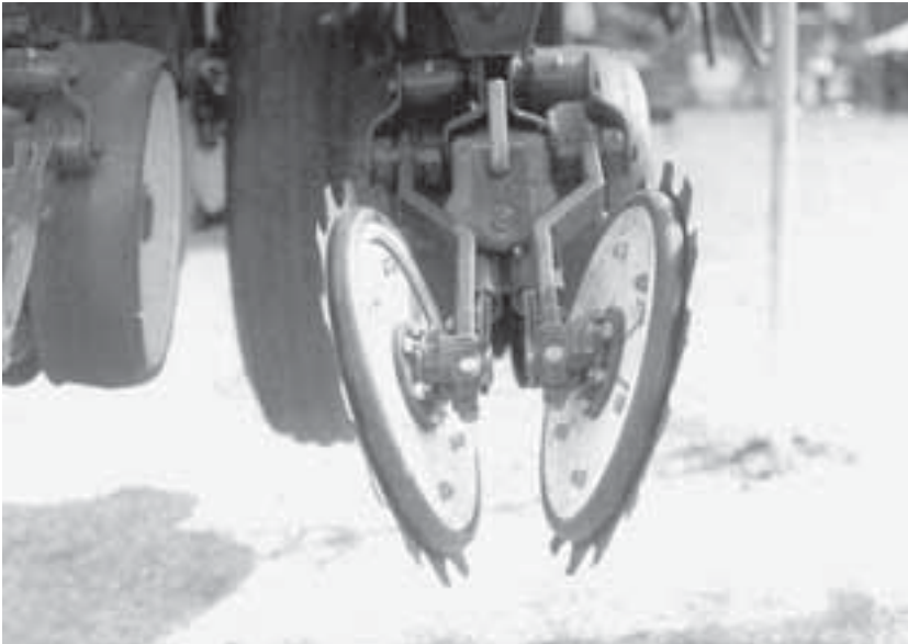
Lámina 39 Un par de discos con puntas combinados con ruedas compresoras anguladas para cubrir ranuras de labranza cero (de Baker et al. , 1996).
