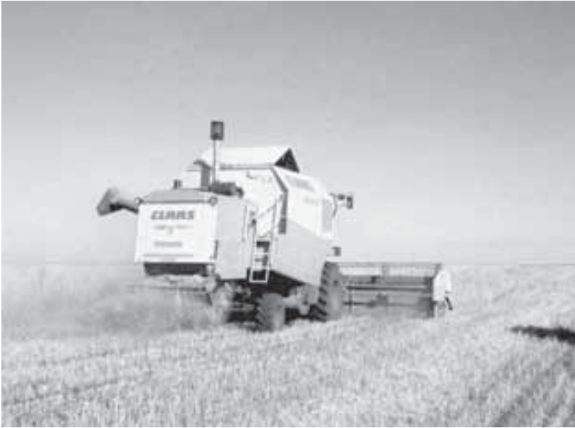
Lámina 62 Distribuidora de paja y de paja fina en una cosechadora. Notar el polvo que provoca la distribución de la paja.
