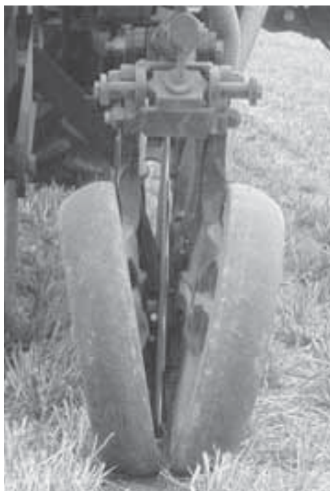
Lámina 46 Soporte flotante para igualar la carga de dos ruedas reguladoras independientes.
