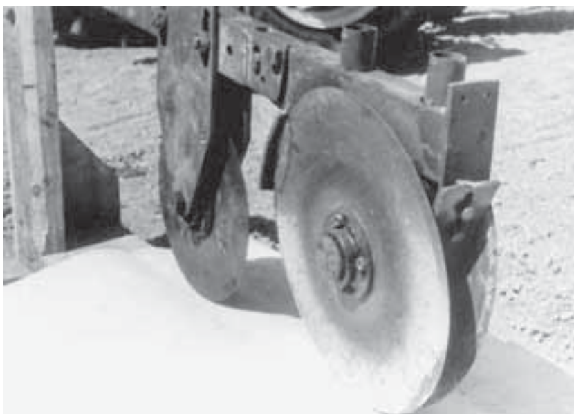
Lámina 4 Típico disco triple para abresurcos para labranza cero que forma surcos verticales en V.
