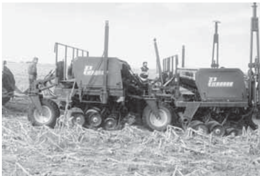
Lámina 92 Unidades sembradoras dobles ordenadas en tándem para obtener una sembradora con espacio entre surcos reducido a la mitad.
