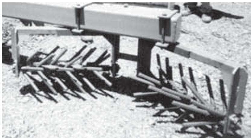
Lámina 119 Herramienta rotatoria para mantenimiento usada para manejar el flujo de suelos plásticos causado por las ruedas. Normalmente, no debería ser usada más de un vez por año (J. Grant, 2001, comunicación personal).
