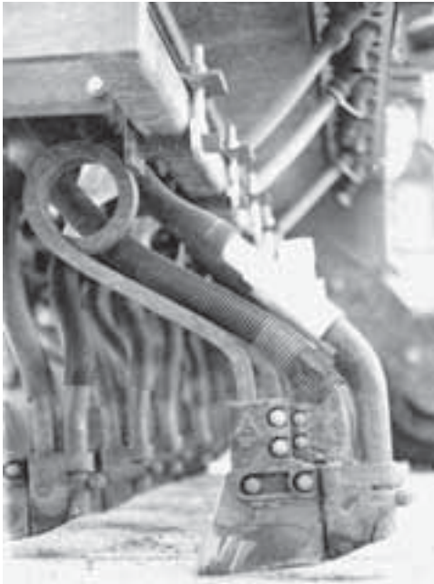
Lámina 22 Sembradora simple con el «Baker boot» en forma de T invertida para abresurcos para labranza cero (de Baker et al. , 1996).
