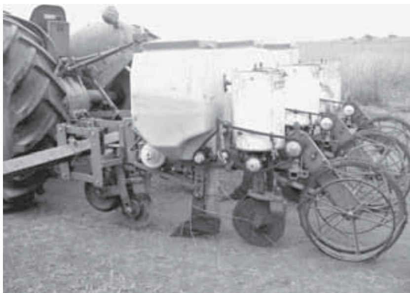
Lámina 106 Pequeña sembradora de precisión adaptada de tracción animal a montaje sobre tractor.
