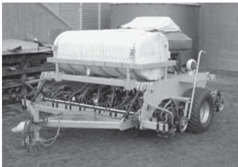
Lámina 88 Sembradora de 4,5 m de ancho para labranza cero sobre marco rígido y con rueda trasera.
