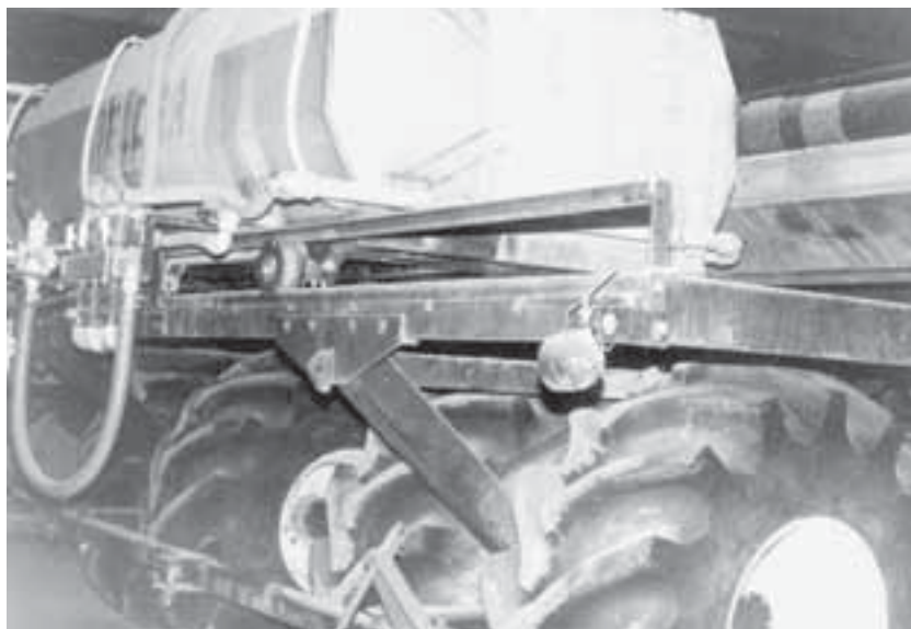
Lámina 95 Una sembradora para labranza cero con un tanque deslizante para fertilizante líquido.
