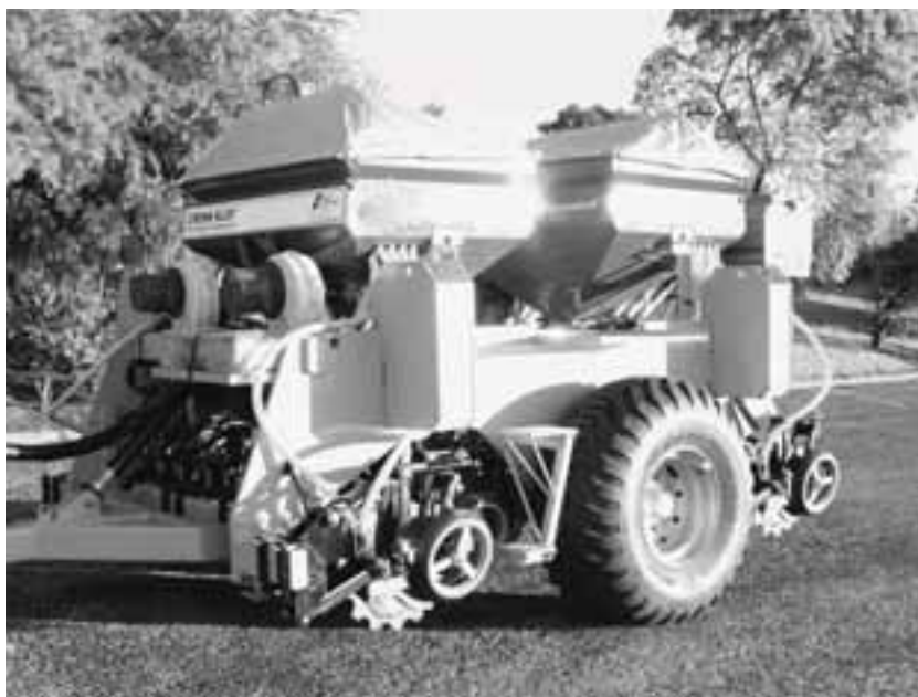
Lámina 55 Diseño avanzado de sembradora por aire para labranza cero.
