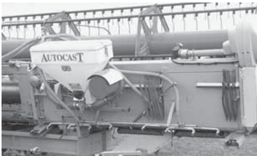
Lámina 29 Sembradora a voleo colocada detrás de la mesa de corte de la cosechadora.
