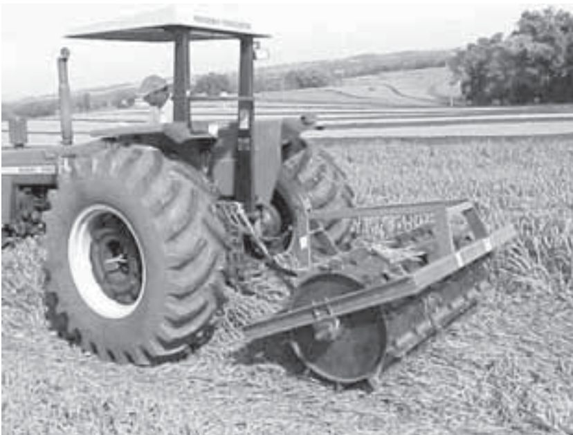
Lámina 65 Cuchillo rotativo tirado por un tractor que trabaja sobre avena.
