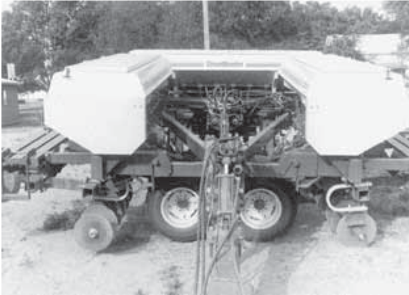
Lámina 93 Sembradoras múltiples dobladas para el transporte.
