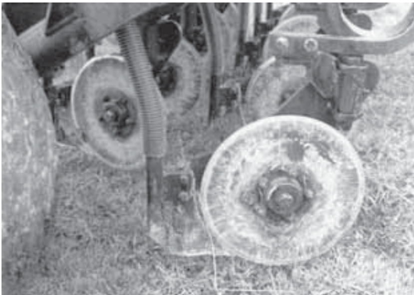
Lámina 23 Sembradora simple con la versión auto-dirigida del «Baker boot» en forma de T invertida para abresurcos para labranza cero.
