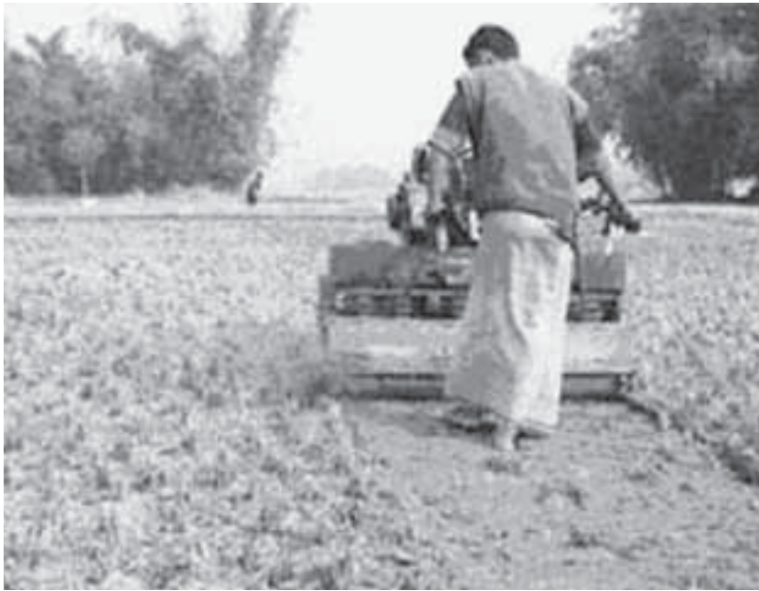
Lámina 113 Máquina de dos ruedas para labranza reducida en trabajo de ancho total.
