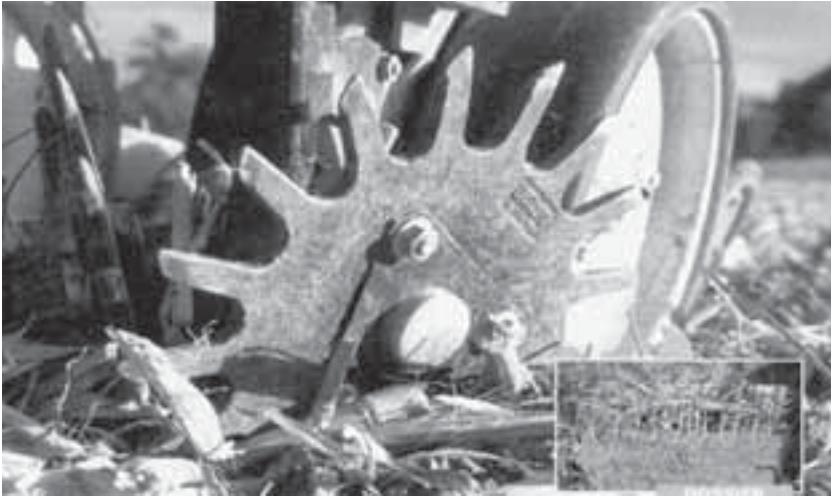
Lámina 69 Un par de ruedas en estrella sincronizadas (limpiadores de surcos) para empujar los residuos hacia un lado.
