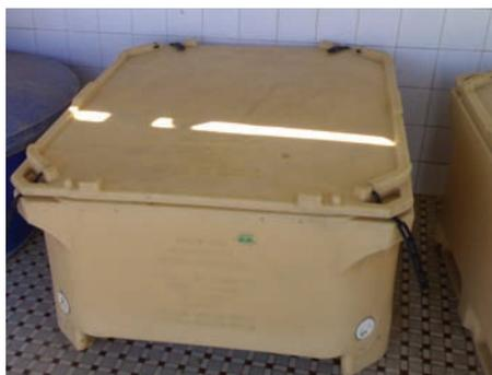
Les cuves sont munies de couvercles et percées d'un petit trou avec un bouchon pour permettre l'écoulement de la saumure usée et une plus grande facilité de nettoyage. Les capacités varient de 100 à 500 kg.
