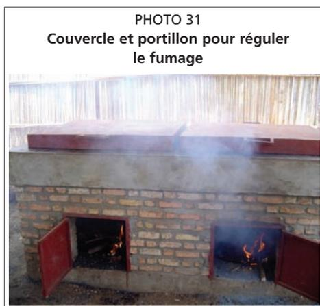
Les fumoirs sont recouverts de couvercles métalliques et les foyers fermés de façon à réguler les flammes et à concentrer toute la chaleur dans le fumoir. Il faut maintenir la hauteur des flammes à un niveau qui évite au produit d'être calciné. La hauteur des flammes ne doit pas excéder 60 cm. Si les flammes deviennent trop fortes, il faut soit régler le tirage, soit les étouffer en les aspergeant d'eau.
