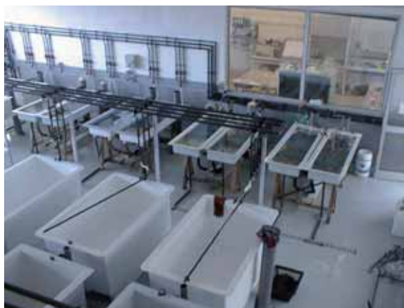
Les installations de quarantaine conçues pour les mollusques sont équipées de plateaux et de bacs spéciaux et peu profonds comme sur cette photographie.
