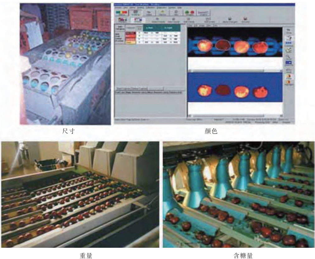
图 7-11 以尺寸（简单的尺寸装备）、颜色（电脑监视的色调）、重量和含糖量为基础用于拣选农产品的分级机
