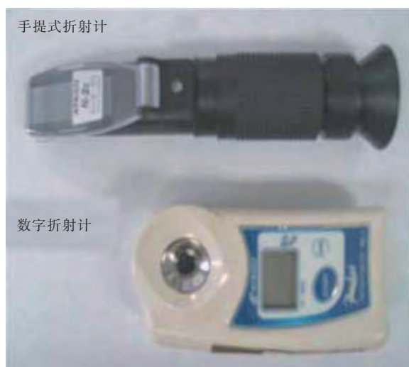
图 IV. 6 手提式和数码式可溶性固体物质含量测量器
