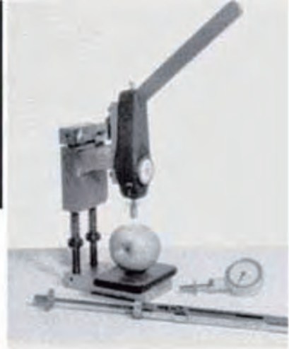
UC 硬度测试器(安装在钻床上的测力计)
