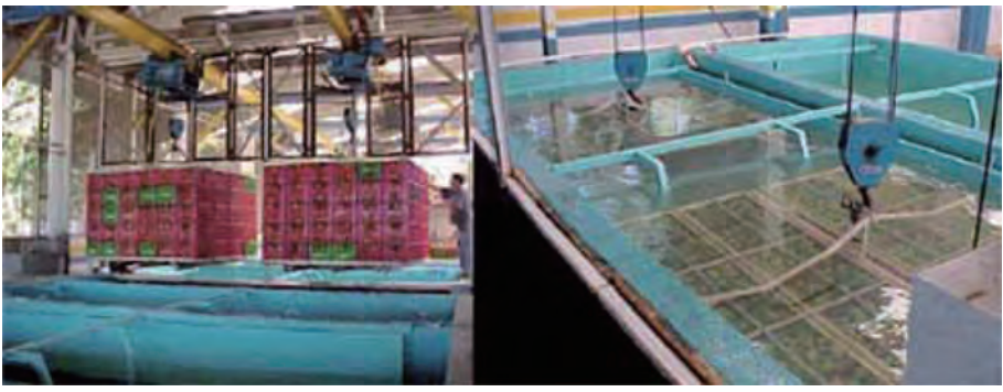
图 7-12 芒果的商业化热水处理设备
