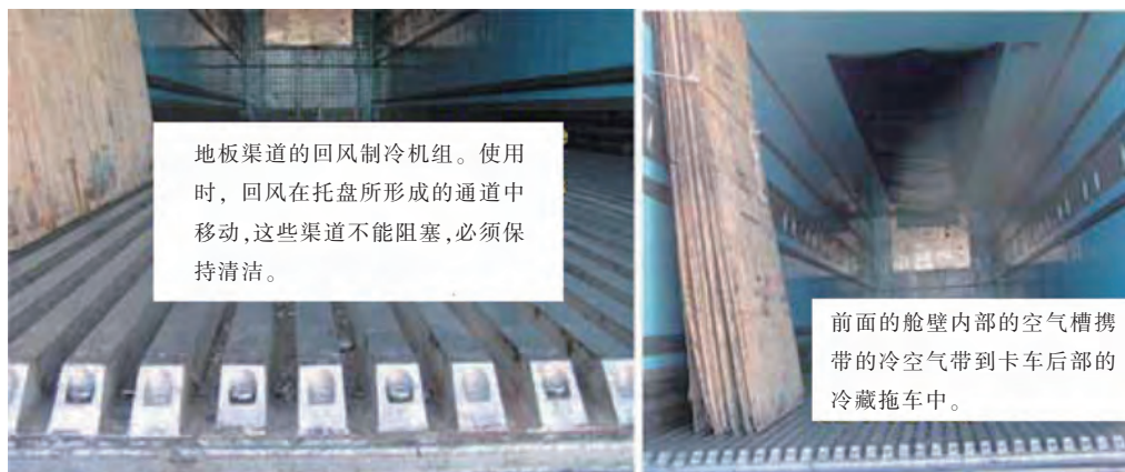
图7-27 冷藏挂车车厢底面的通道和顶部的空气流通道
