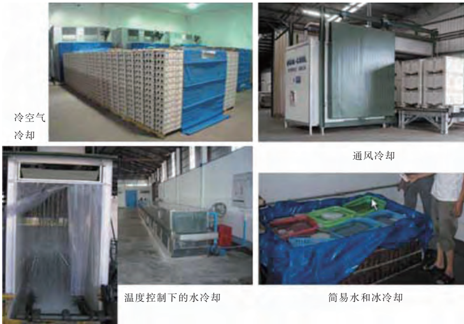
图 7-21 新鲜水果的通风冷却、真空冷却、水冷却
