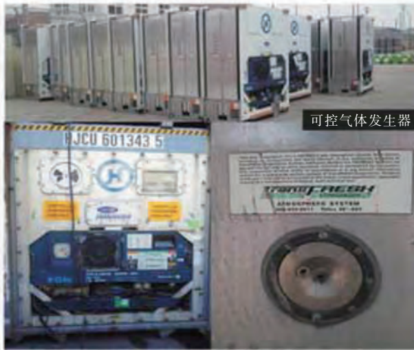
图 7-29 配有可控气体发生器的冷藏室
