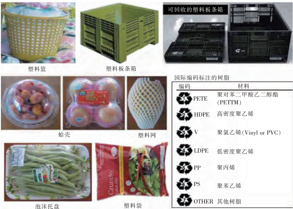
图 7-18 用于包装果蔬的塑料质包装箱和包装材料以及用来生产包装材料的塑料树脂的国际编码 来源: K. Tanprasert。
