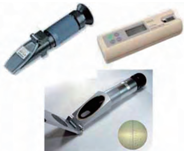
图 7-6 用于测量可溶性固体物的折射计
