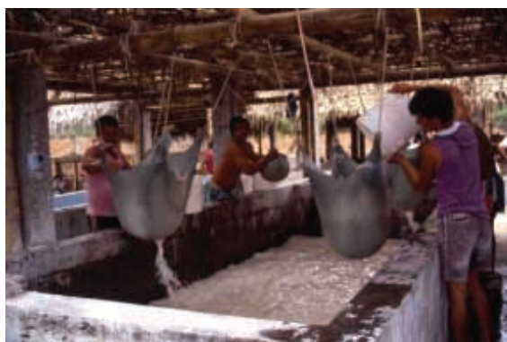
Lámina 17 Colado de pulpa o material fibroso
