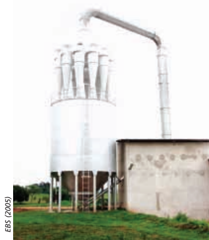
Lámina 38 Secador «flash» y silo de enfriamiento
