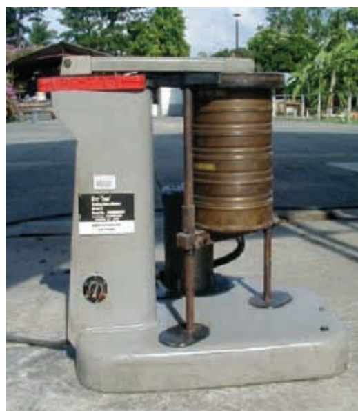
Lámina 40 Equipo de tamizado de tipo Ro-tap.
