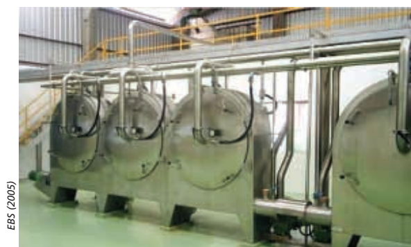
Lámina 32 Tamizadoras o extractoras
