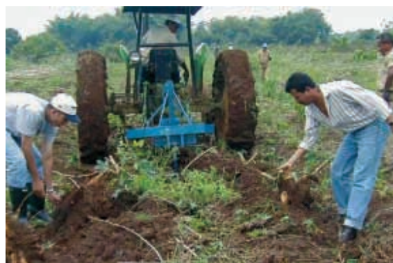
Lámina 10 Cosecha mecanizada de yuca usando cosechador flexible
