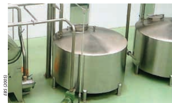
Lámina 33 Tanque pulmón o de bombeo
