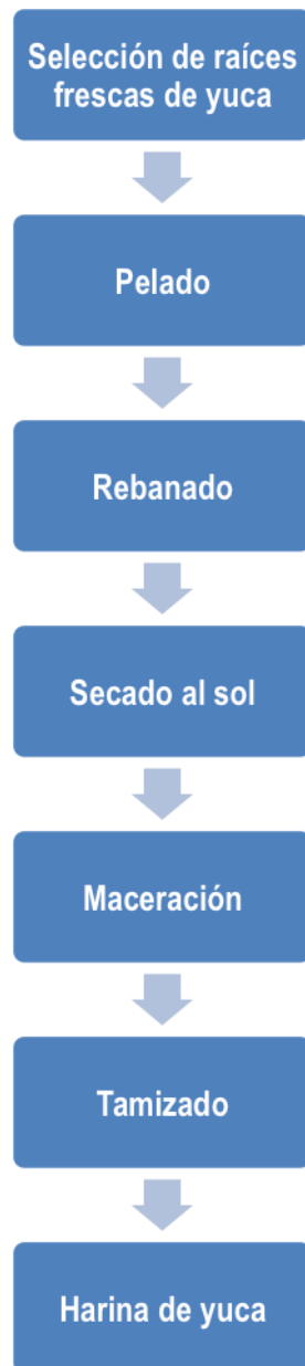
Gráfico 4. Diagrama de flujo de la producción de harina de yuca sin fermentar
