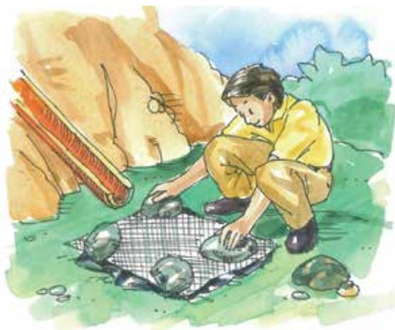
6. Colocar una pieza de tubo PVC en el fondo del primer agujero para que sirva como salida del agua filtrada. Las conexiones de tubería entre cada agujero serán subterráneas. Para introducir este tubo, se puede cavar al mismo tiempo una zanja angosta a la par del agujero. Se introduce por allí el tubo y, ya colocado, la zanja se vuelve a llenar con tierra.
