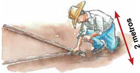
4. Se colocan las estacas que servirán de base para la medición. Las estacas son puntos fijos importantes que nos sirven para colocar las patas del nivel. Es importante fijarse que donde se colocan al principio ahí se colocarán después, en el momento en que se esté nivelando el aparato.
