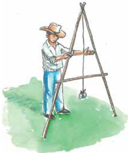
6. Colocar las patas del Nivel tipo A sobre las estacas que se ubicaron en el suelo. Marcar el lugar en el que marca la plomada.
