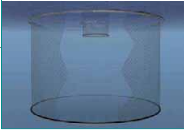
FIGURE 22 Exemple de développement d'utilisation de plus grandes unités. Augmentation d'une circonférence de 40 m et d'une profondeur de 4 m à une circonférence de 157 m et à une profondeur de 30 m, créant une augmentation de volume de 510 m 3 à 59 000 m 3
