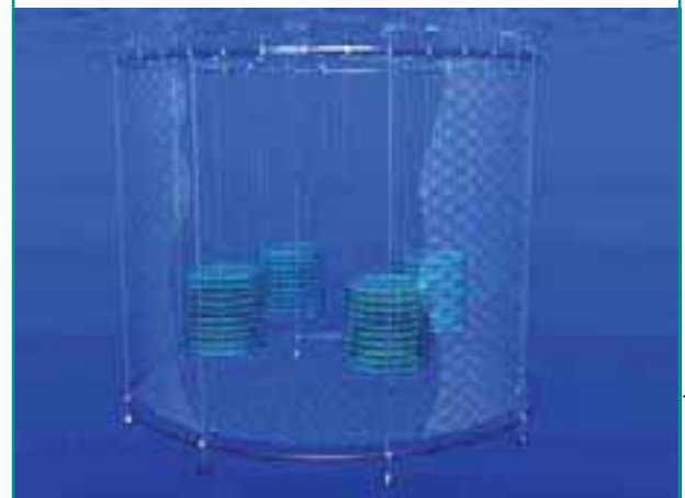
FIGURE 13 Exemple de cage adapté aux poissons plat
