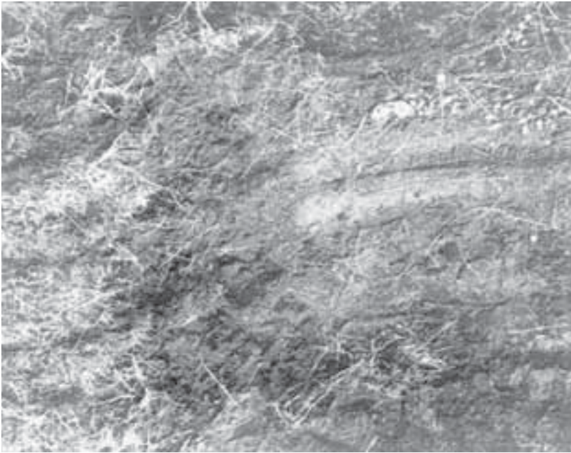
Lámina 51 Ejemplo de un excelente seguimiento de la superficie a través de un hueco por un abresurco para labranza cero (fuerza de penetración gas-aceite).
