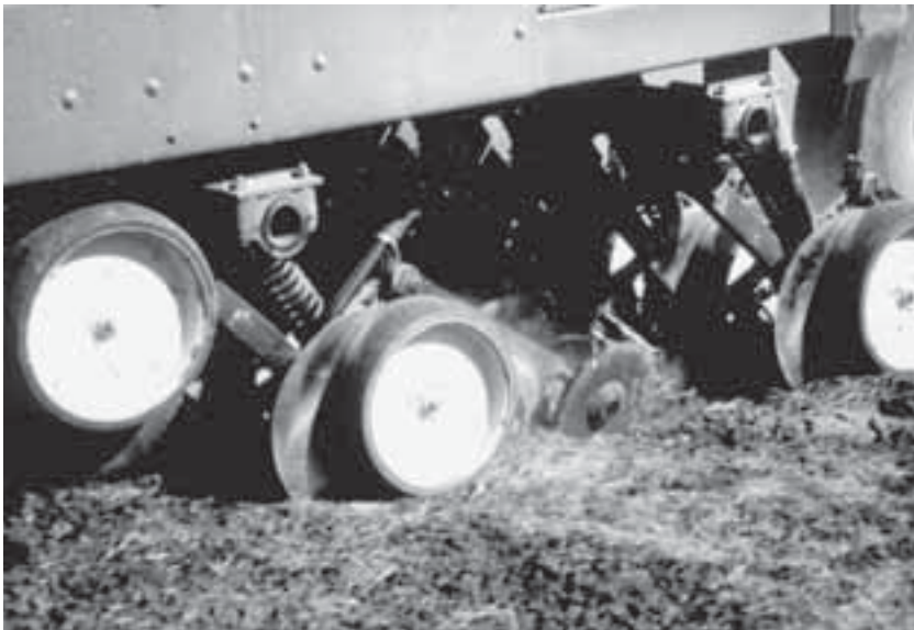
Lámina 45 Ruedas para regular la profundidad colocadas a lo largo del punto de depósito de las semillas en abresurcos para labranza cero.
