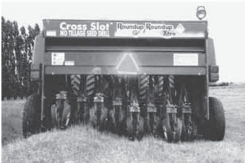
Lámina 52 Ilustración de la extraordinaria capacidad para seguir la superficie de un abresurcos con sistema gas-aceite para penetración vertical en una siembra para labranza cero.
