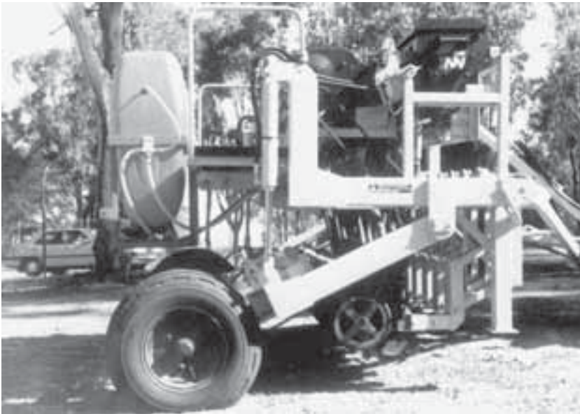
Lámina 132 Ejemplo de una sembradora universal para parcelas.
