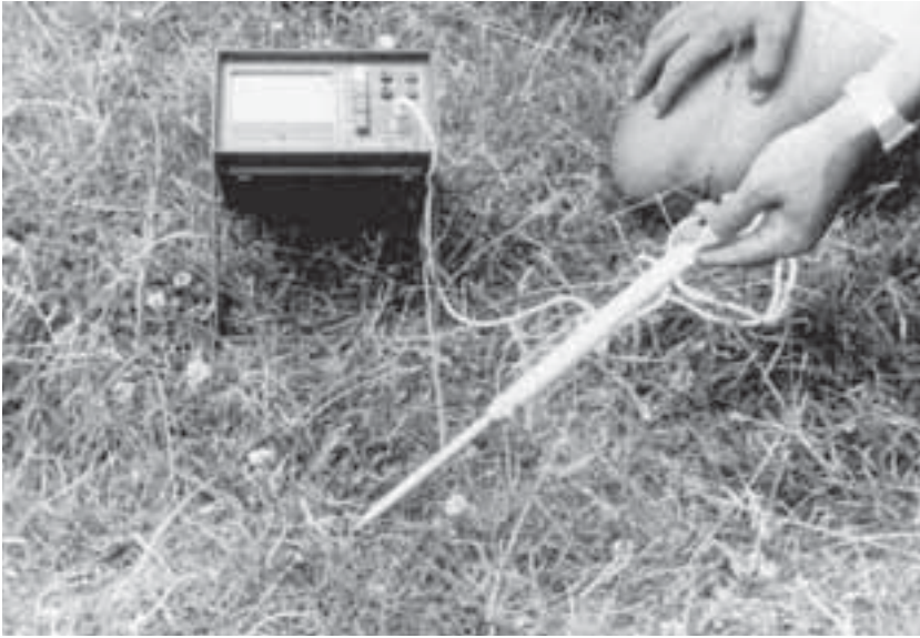
Lámina 123 Muestreo de la humedad del suelo en el campo.
