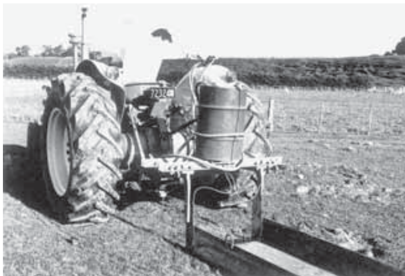
Lámina 120 Una cuchilla circular para cortar suelo unida a un recipiente para extraer bloques de suelo sin disturbar (de Baker, 1969a).
