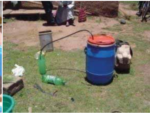
Sellado anaeróbico del turril
