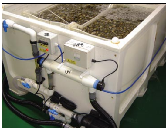
Figure 6.3: Unité de traitement UV reliée au système de purification d'un petit bassin peu profond
