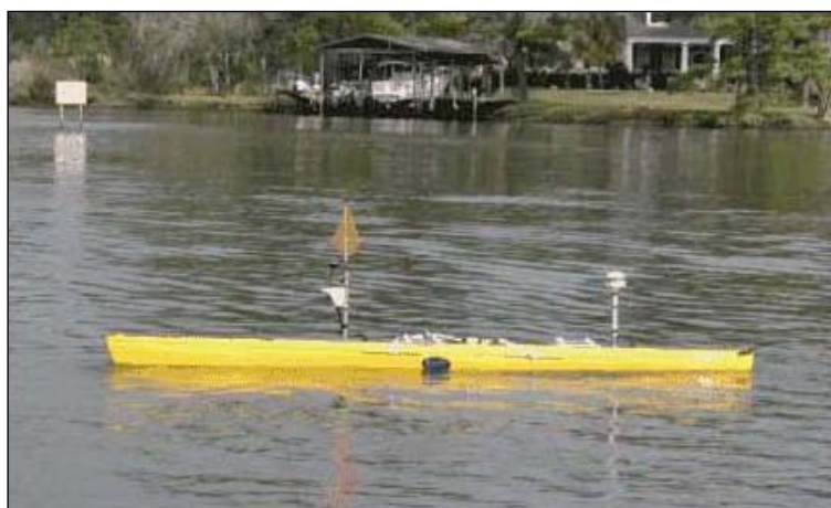
FIGURE 13 Véhicule autonome de surface (ASV) utilisé pour la recherche dans le golfe du Mexique
