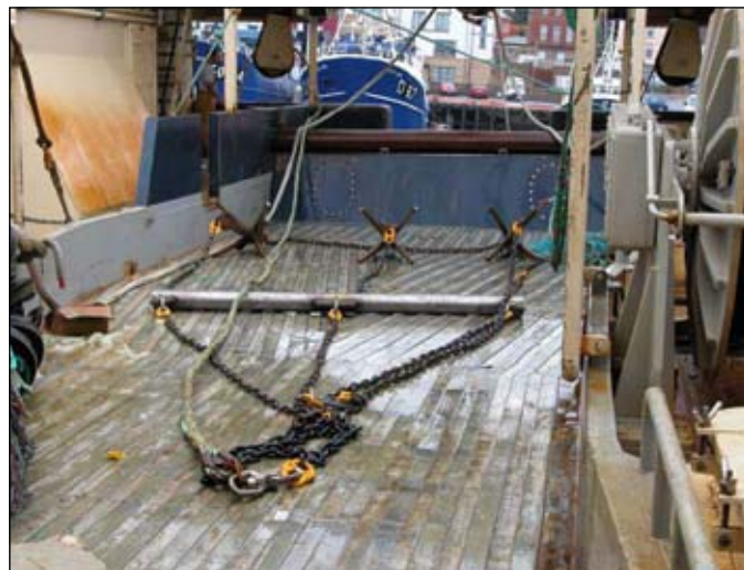
FIGURE 14 Drague pour la récupération de filets maillants à bord du MFV India Rose
