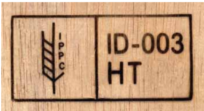
国际植保组织规定的木质包装材料标记范例包括：ISPM 第15号标识、ISO双字母国家代码（ID代表印度尼西亚），后随由国家植保机构给予生产者的特殊号码，以及ISPM 第15号处理方式代码（HT表示热处理）
