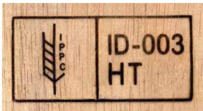
Exemple de marque de la CIPV sur un matériau d'emballage en bois, comprenant: le symbole de la NIMP n° 15, un code de pays ISO à deux lettres (ID pour Indonésie) suivi d'un numéro unique assigné au producteur par l'ONPV, et le code du traitement de la NIMP n° 15 (HT pour traitement thermique)
