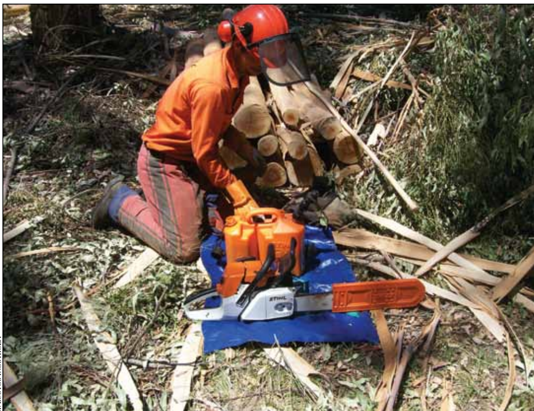
Durante la sesión de evaluación, un operador de motosierra introduce combustible en el estanque de su máquina
