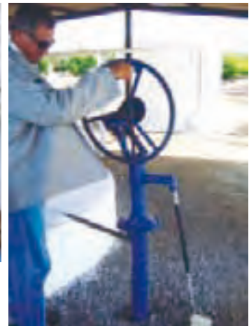
Modelo manual sencillo, pero ligeramente más grande y pesado que los anteriores. Posee manija de movimiento circular, lo que permite cierto movimiento inercial, es decir, el movimiento de bajada del brazo ayuda en parte al movimiento de subida. Si las necesidades de agua son mayores, este modelo sería más adecuado que los presentados anteriormente. Foto: Marcos J. Vieira.
