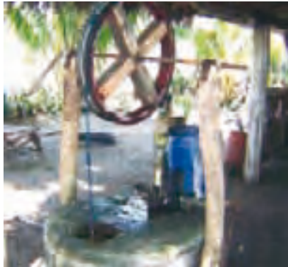
Cuerda y puela: Sistema sencillo de extracción de agua en el que no hay bombeo. Está compuesto por un balde, cuerda, puela y manija, con movimiento circular. Es poco eficiente y laborioso, principalmente si el agua se destina a otros usos que no sean el estrictamente doméstico y unos pocos animales de corral. El contacto del balde, el cual es manoseado, con el agua suele ser una causa de contaminación del pozo. Foto: José Cristóbal E. Betancourt
