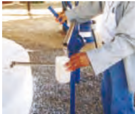
Modelo manual sencillo, similar al anterior. La manija es de movimiento semicircular horizontal sin movimiento inercial, es decir, cada movimiento hacia un lado (el que produce agua) necesita que el movimiento contrario sea realizado con esfuerzo del brazo, aunque leve. Hay en el mercado modelos más grandes. Foto: Marcos J. Vieira.
