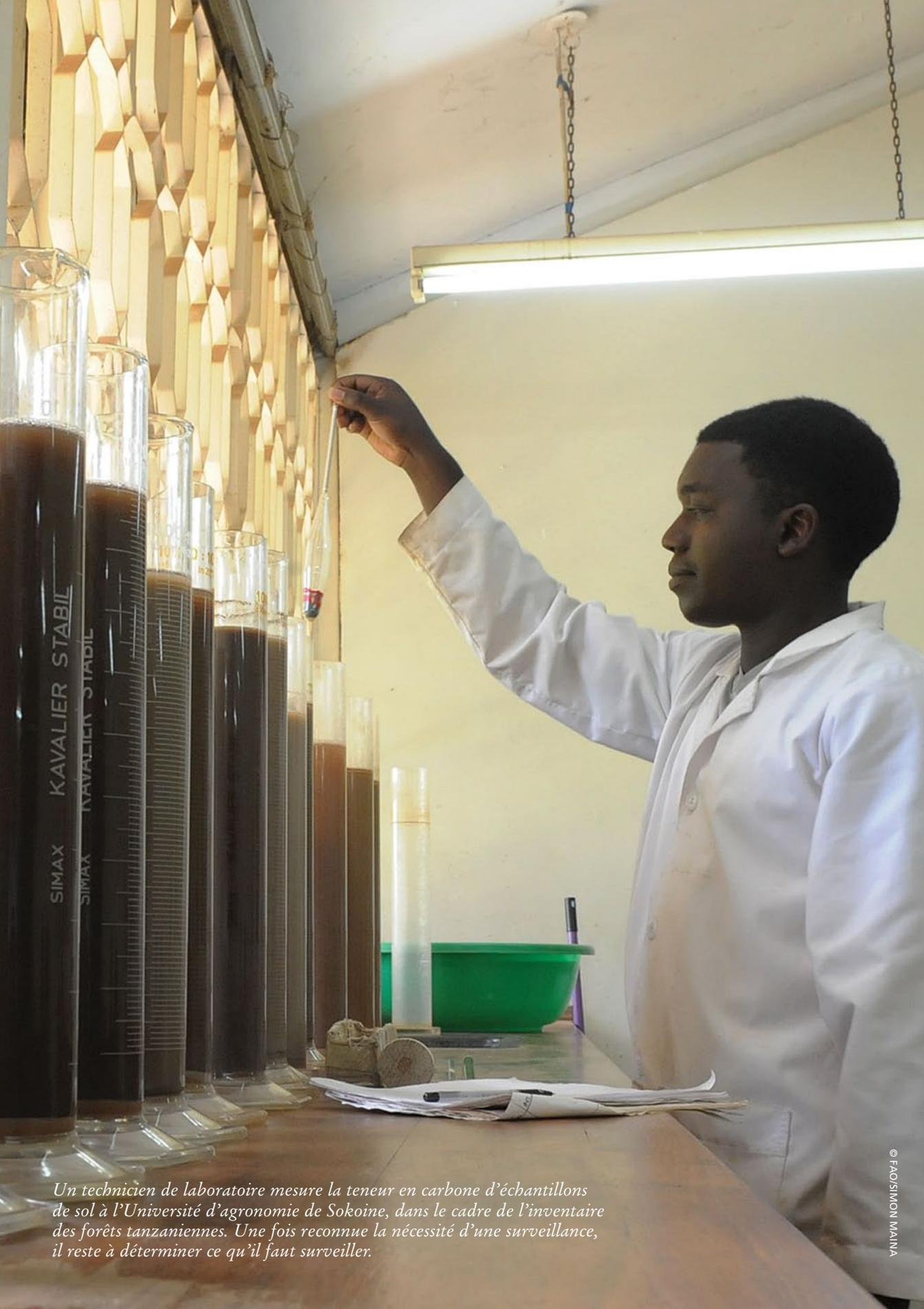
*Un technicien de laboratoire mesure la teneur en carbone d'échantillons de sol à l'Université d'agronomie de Sokoine, dans le cadre de l'inventaire des forêts tanzaniennes. Une fois reconnue la nécessité d'une surveillance, il reste à déterminer ce qu'il faut surveiller.*
