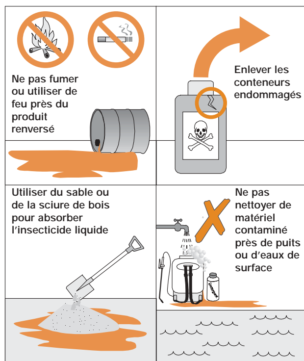
Figure 29. Conduite à tenir en cas de renversement accidentel d'insecticide.
