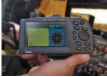
جهاز تحديد المواقع، يظهر هنا محملاً في قمرة قيادة طائرة رش، تحسّن دقة عمليات الرش بقدر كبير.
