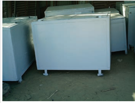
PHOTO 11 Revêtement extérieur en bois peint de couleur claire à l'huile pour le protéger de l'humidité ambiante et des effets des rayons solaires
