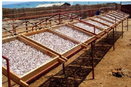
PHOTO 49 Séchage sur claies horizontales inclinées
