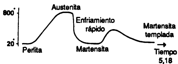
Figura 4.18 ESTRUCTURA DEL ACERO AL CARBONO
