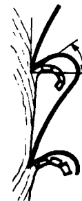
Angulo de corte positivo y abierto en las sierras de corte longitudinal
