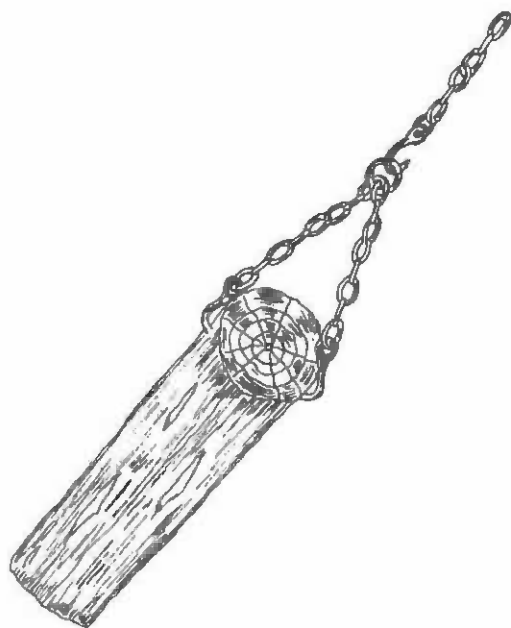
Figure 19. Chaîne munie de pinces pour le transport de grumes de grand diamètre
