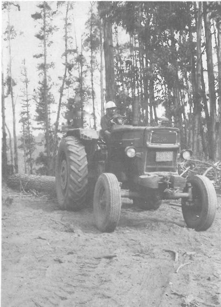
Figure 43. Débardage de grumes à l'aide d'un tracteur agricole doté d'un treuil (Lastarria, Chili)
