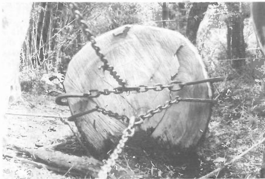
Figure 38. Placement frontal de pinces fixées à des traits - système de débardage appelé "cuarteo" (Neltume, Chili)
