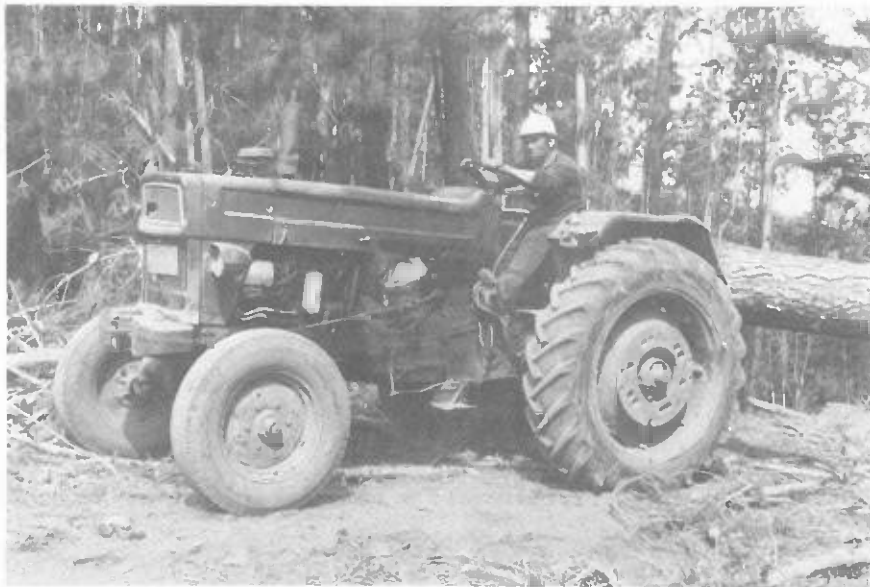
Figure 45. Débardage avec un tracteur agricole employant la poulie supérieure du treuil (Lastarria, Chili)
