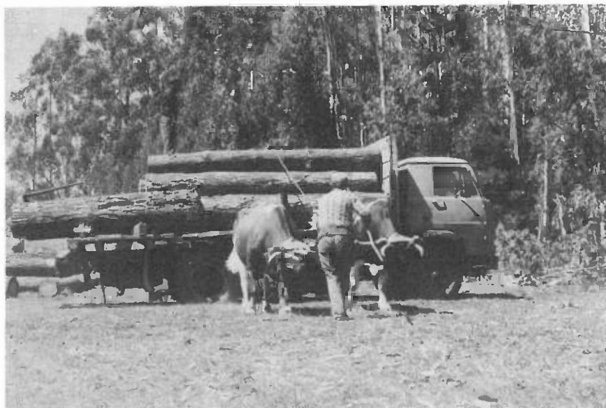
Figure 12. Chargement latéral de grumes à l'aide de boeufs dans des forêts secondaires (Lastarria, Chili)
