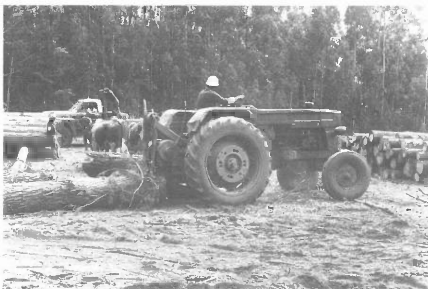
Figure 46. Débardage avec un tracteur agricole employant le tambour du treuil (Lastarria, Chili)
