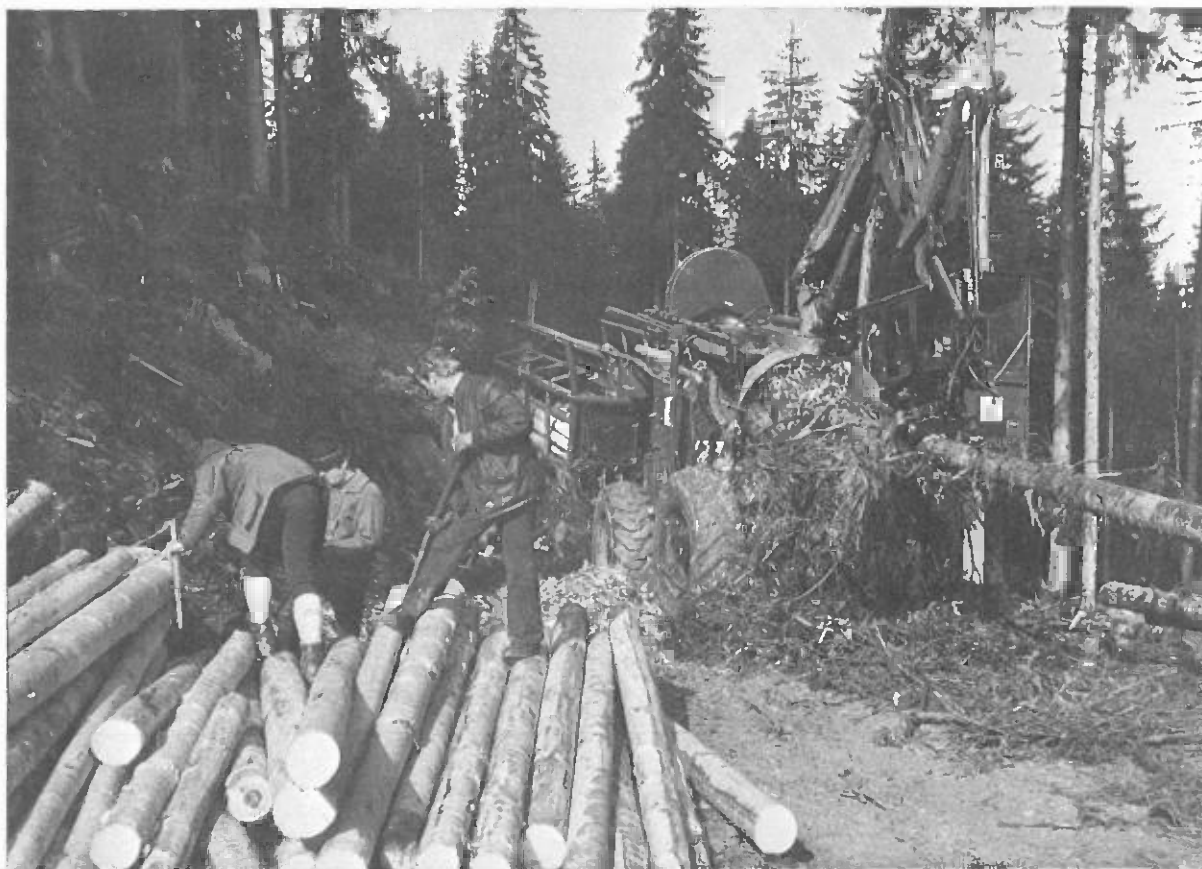
"Processeur" reprenant des fûts entiers pour les ébrancher, les écorcer, les tronçonner et les classer en assortiments (Photo: O. Sedlak)
