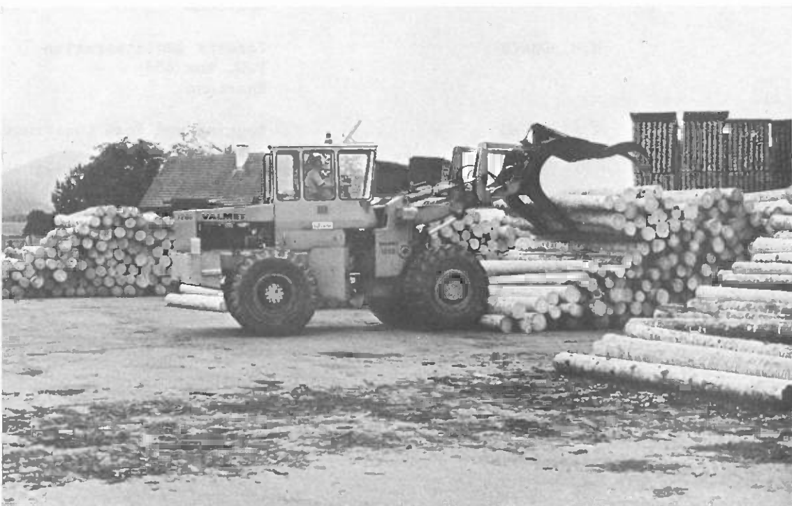
Chargeur à grappin sur roues empilant et transportant des grumes dans une scierie (Photo: R. Heinrich)
