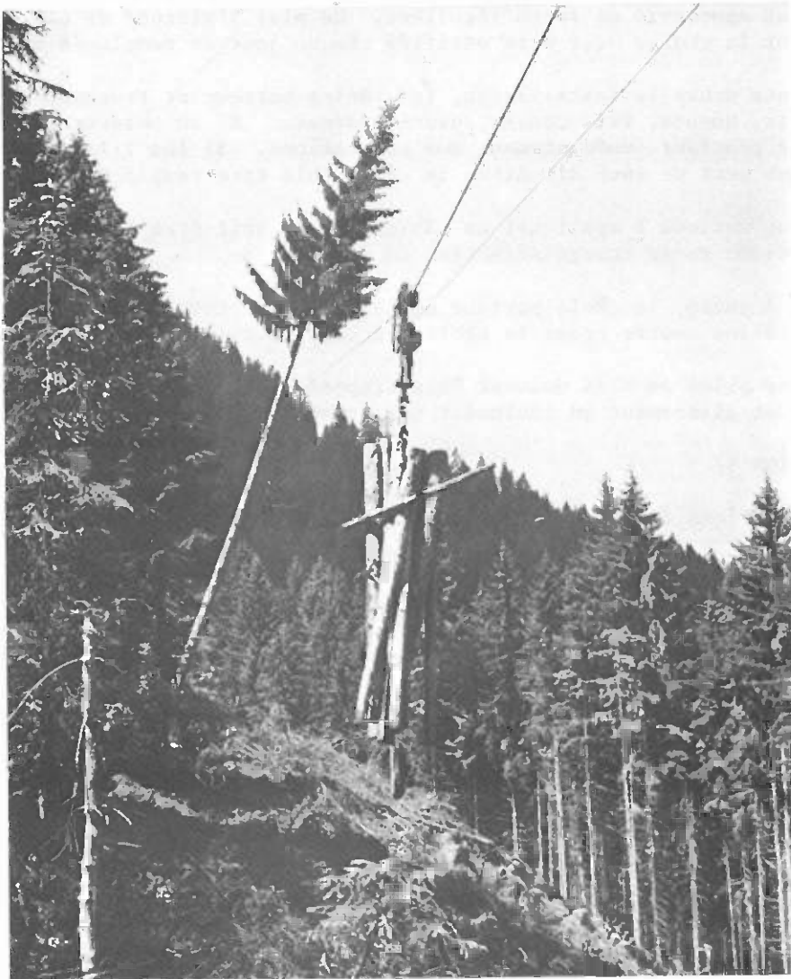
Arbre servant de support intermédiaire dans une opération de câble-grue (Photo: E. Pestal)
