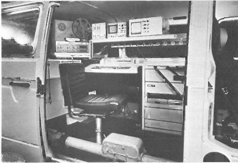
Equipement de télémesure et de traitement électronique des données installé dans un minibus Volkswagen (Photo: Institut fédéral de recherches forestières)
