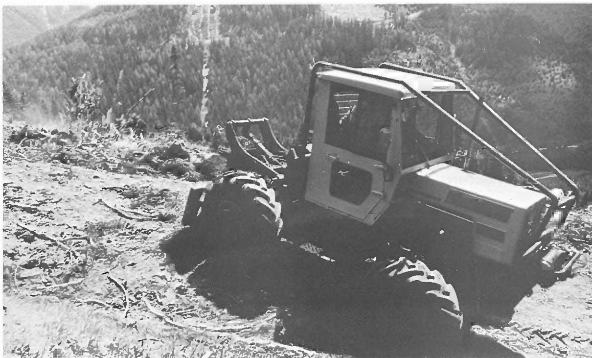
Les tracteurs porteurs ont été utilisés avec succès dans les zones de chablis ou pour le transport de petites quantités de bois dans les forêts des fermes (Photo: E. Pestal)
