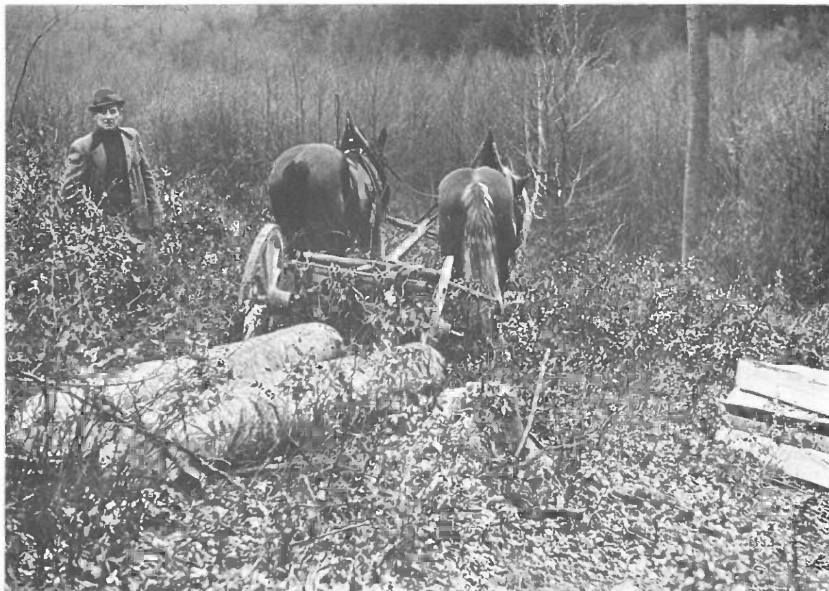
Débardage traditionnel par des chevaux, utilisant un avant-train en bois à deux roues (Photo: E. Pestal)
