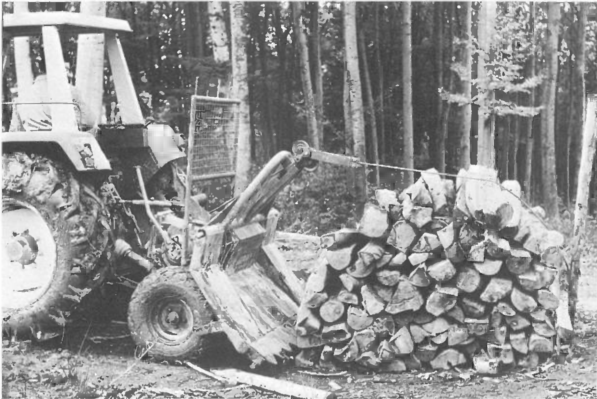
Tracteur agricole équipé d'un arrière-train employé pour le transport du bois de feu sur de courtes distances (Photo: Steyr)
