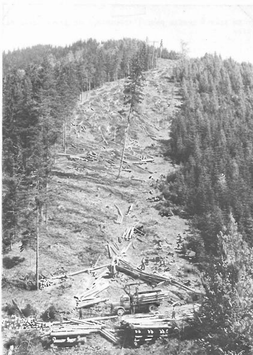
Coupe à blanc par bande et transport de grumes vers la vallée au moyen de câble-grue. Chargement d'un grumier avec un chargeur hydraulique (Photo: Institut fédéral de recherches forestières)
