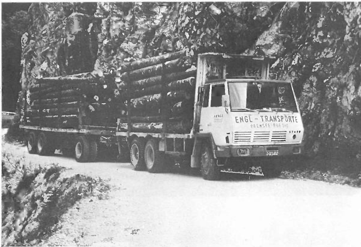
Transport de grumes sur remorque attelée à un camion à plate-forme sur route forestière étroite en terrain montagneux (Photo: R. Heinrich)
