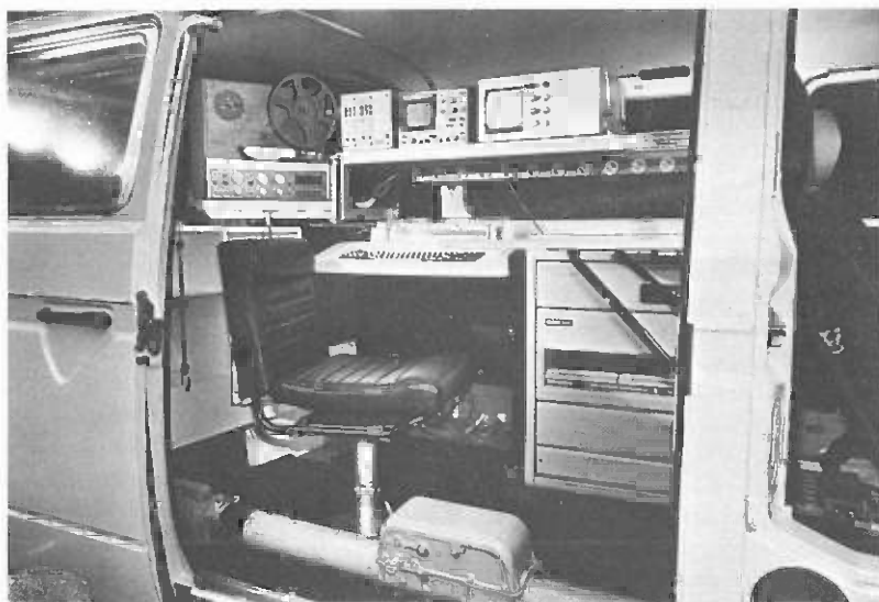
Equipo de telemetría EDV 1/ incorporado a una furgoneta Volkswagen (Foto FBVA 2/ )
