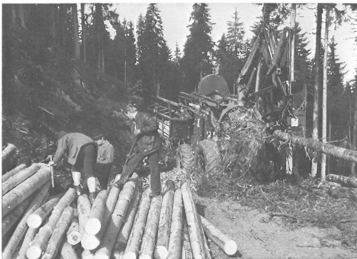
Procesadora recogiendo trozas de troncos enteros para desramar, descortezar, tronzar y clasificar (Foto: O. Sedlak)
