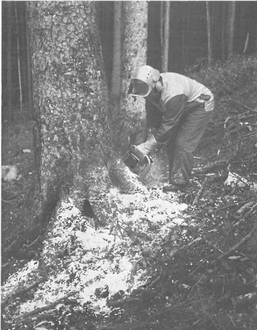
Operario de motosierra, equipado con indumentaria de seguridad, haciendo el corte de apeo (Foto: O. Sedlak)
