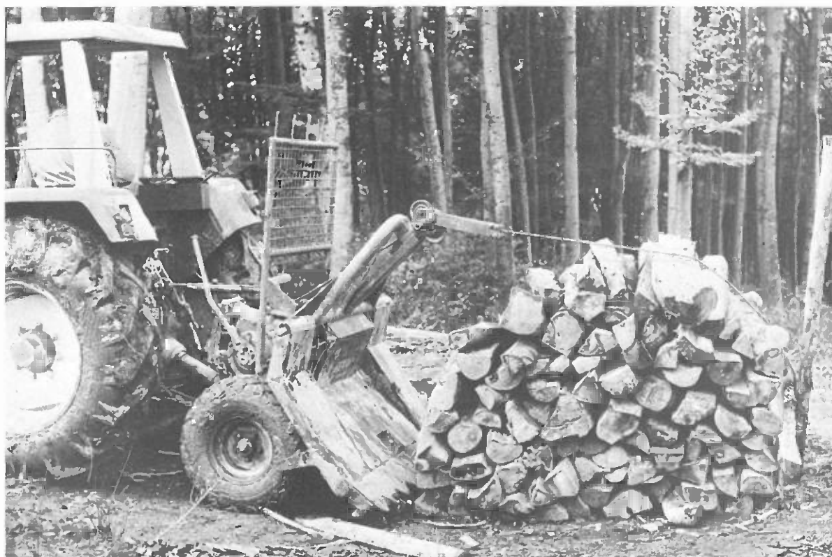
Tractor agrícola equipado con vagoneta giratoria, empleado para el transporte de leña a cortas distancias (Foto: Instituto Federal de Investigaciones Forestal)
