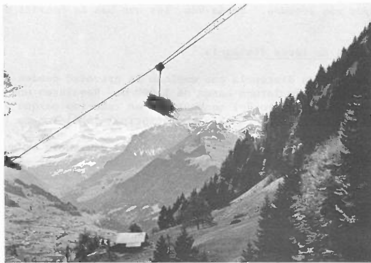
Transporte de fajos de ramillas y ramas mediante cable (Foto: Wyssen)
