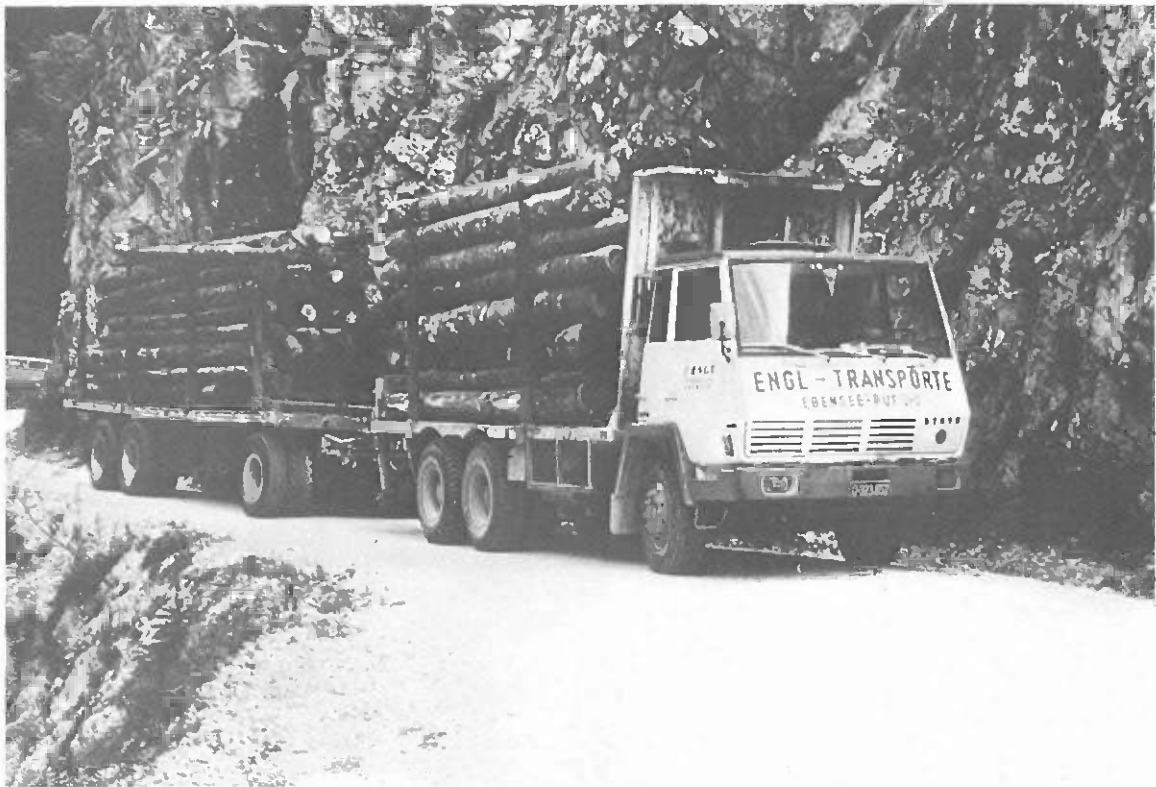
Transporte de trozas mediante camión de plataforma plana con remolque (estrecho) por una carretera forestal estrecha, en terreno de montaña (R. Heinrich).
