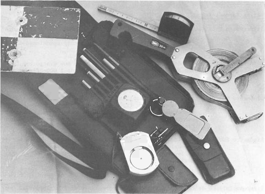
Estuche de ingeniería con instrumentos (Foto: O. Sedlak)
