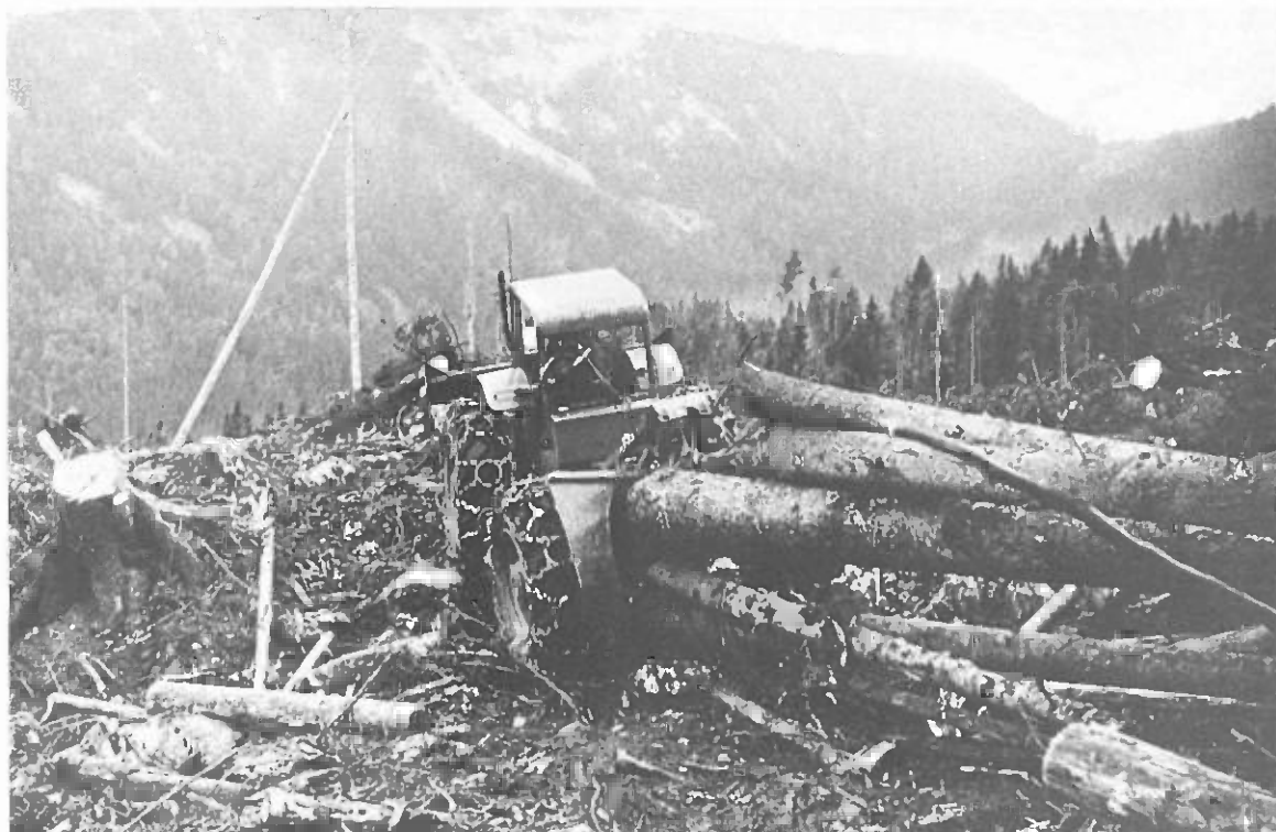
Tractor arrastrador articulado, de ruedas, equipado con cadenas antideslizantes, extrayendo grandes trozas de troncos enteros (Foto: Instituto Federal de Investigación Forestal)
