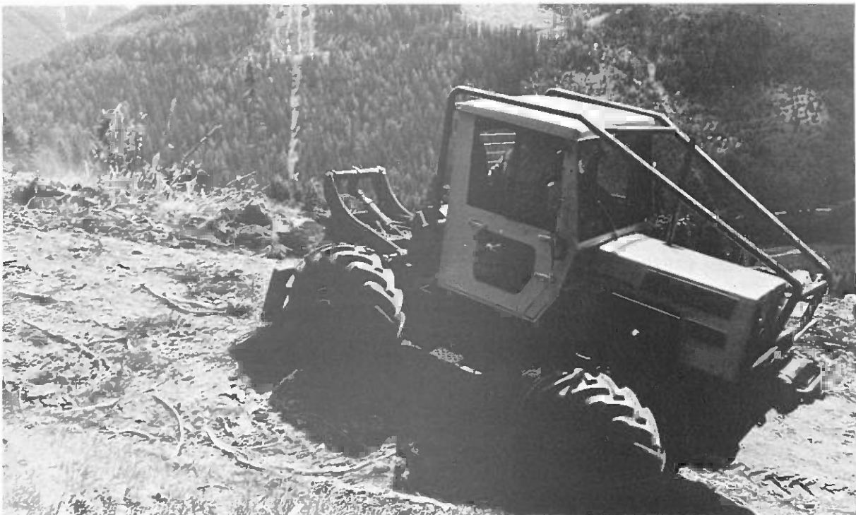
El MB-Trac ocupa el espacio entre un tractor agrícola y un tractor arrastrador. Su equipo de cable y una cabina confortable para dos hombres le hacen cada vez más popular. (Foto: E. Pestal)
