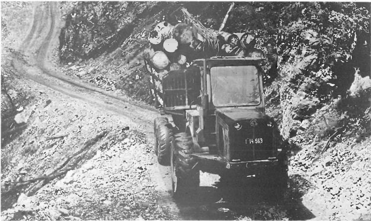
Los tractores forestales cargadores se han empleado con éxito en zonas con madera dañada por el viento y para el transporte de pequeñas cantidades de madera en bosques de fincas agrícolas (Foto: E. Pestal)
