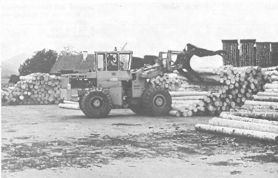
Cargador de garras con ruedas, apilando y transportando trozas para un aserradero (Foto: R. Heinrich)
