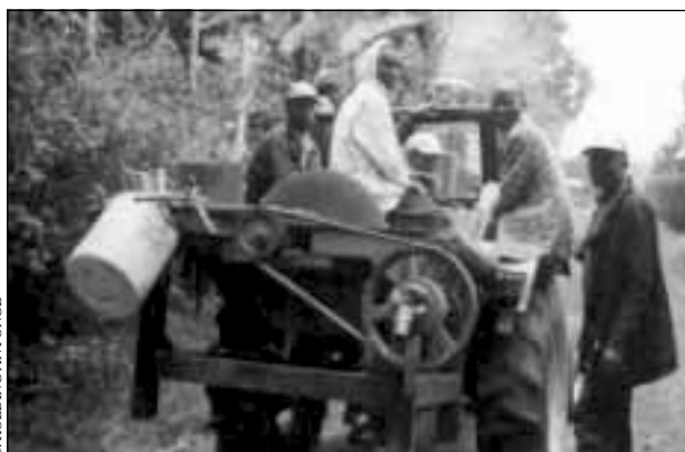
Scie circulaire à câble, sur tracteur au Kenya
