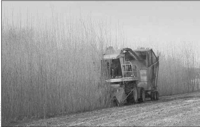
Les taillis à courte révolution du saule sont exploités tous les trois à cinq ans, pendant l'hiver quand le sol est gelé, à l'aide de machines conçues expressément
