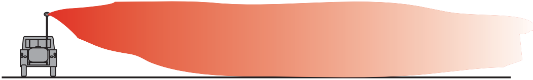
ب . آلة رش للحجوم المتناهيه فى الصغر (ULV) محمولة على سياره
