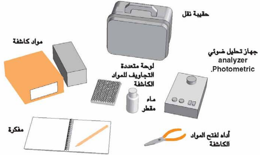
شكل ٣٢. مكونات حقيبة الاختبار الحقلى للكولين استريز.
