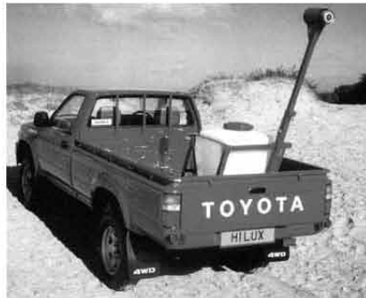
شكل ٢٠. ميكرون طراز AU7010 محمول على سيارة بيك - أب (هذا الطراز توقف)
