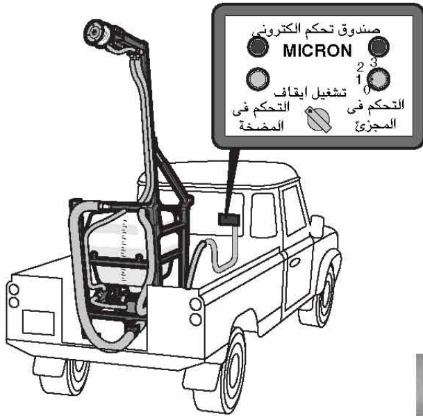
شكل ٢٠. ميكرون طراز AU7010 محمول على سيارة بيك - أب (هذا الطراز توقف)
