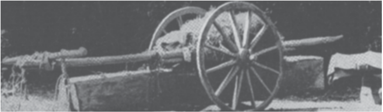
En algunas regiones apartadas de la India, donde la producción podría aumentar mucho si se dispusiera de mejores caminos y de equipo moderno, se usan todavía carretas de ruedas grandes, tiradas por cebú para el transporte de las trozas de Shorea robusta. Este medio de transporte es tan lento que hace necesario llevar pienso para alimentar a los bueyes en el camino.
