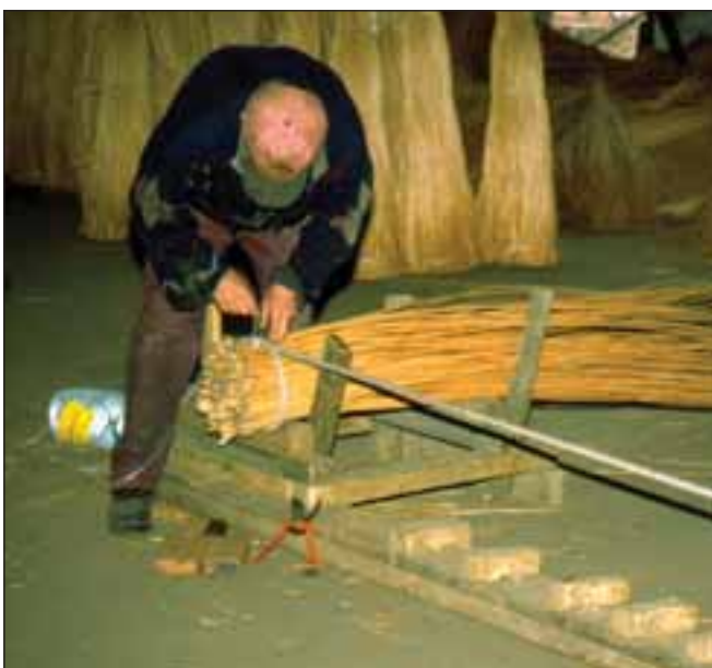
Clasificación y formación de haces de varillas por longitud, diámetro y defectos
