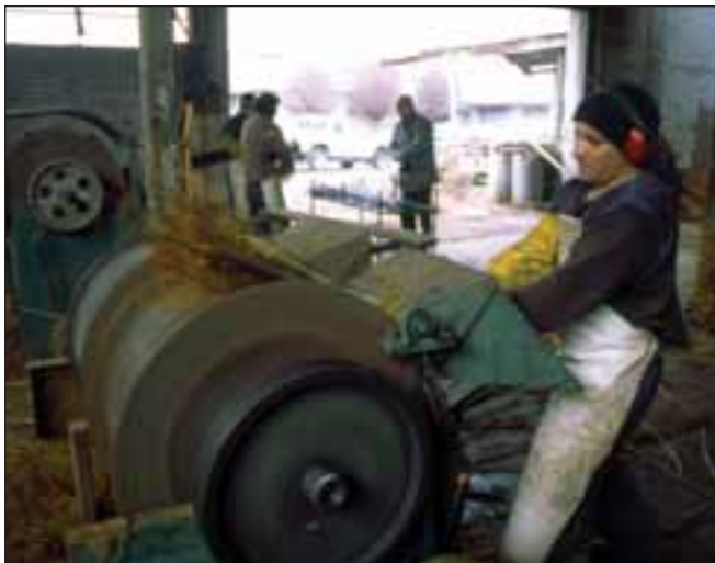
Los productores en gran escala utilizan máquinas eléctricas para retirar la corteza
