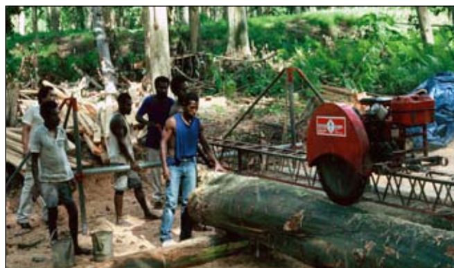
Un aserradero móvil en funcionamiento en el bosque, Papua Nueva Guinea
