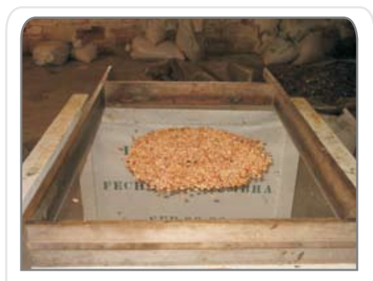
Figura 80. Zaranda para separar los granos de frijol por tamaño y separar impurezas
