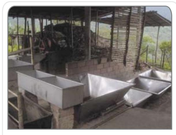
Figura 66. Hornilla panelera
