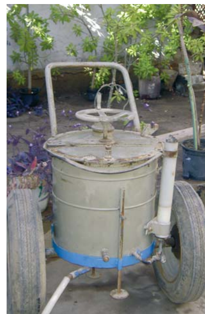
Figure 2. Applicateur d’engrais portable de grande dimension, doté d’un agitateur manuel.
