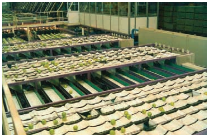
Figure 36: Triage en fonction du poids. Des plateaux individuels déposent les fruits sur le tapis roulant correspondant.
