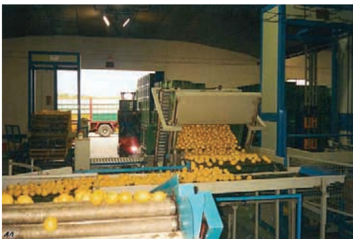
Figure 29: Déchargement à sec de citrons (Photographie: P. A. Gómez, INTA E.E.A. Balcarce).
