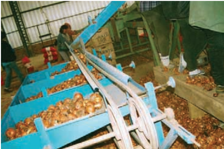
Figure 33: Calibrage des oignons par courroies divergentes. Les différentes vitesses des courroies font tourner les bulbes et, dans le même temps, les font avancer vers un point où le diamètre du bulbe est égal à l'écart entre les courroies.
