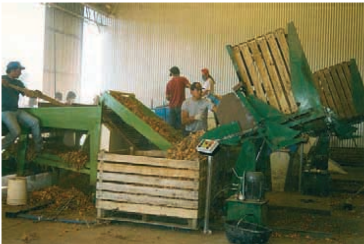
Figure 31: Renversement des oignons avant le calibrage.
