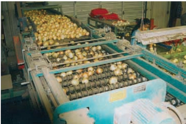
Figure 34: Calibrage à l'aide de rouleaux de plus en plus espacés.
