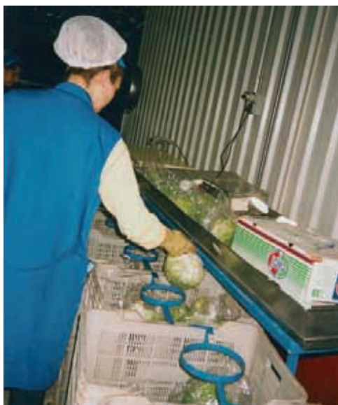
Figure 35: Calibrage à l'aide d'anneaux de diamètres établis (Photographie: P. A. Gómez, INTA E.E.A. Balcarce).
