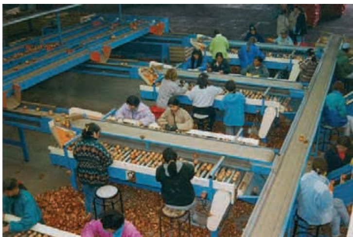
Figure 38: Système de tri qualitatif dynamique. Les bulbes d'oignon triés par taille défilent en continu sur les tables de sélection d'où les éléments défectueux sont retirés. Une inspection finale est effectuée avant l'emballage (sur la droite).
