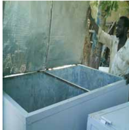
Figure 4. Intérieur d'un conteneur adéquatement isolé
