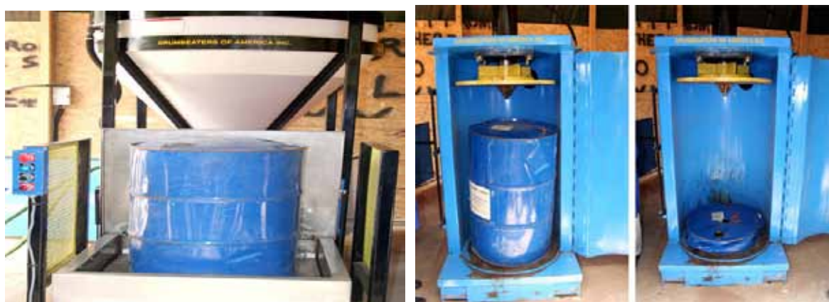
Figure 8: Équipement mécanisé de rinçage au solvant et de compactage des fûts
