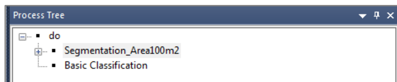
Figura 60. O processo “ Basic Classification ” é adicionado no mesmo nível hierárquico do processo de sementação da imagem no software eCognition.
