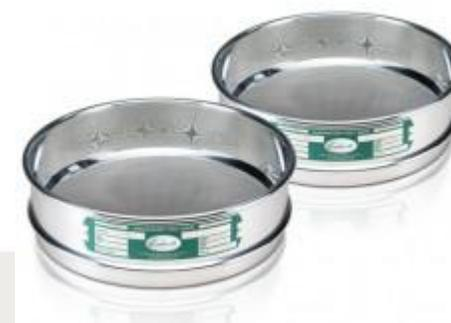
En général, si on pèse une masse  $>1$  g, on peut utiliser un échantillon de sol tamisé à 2 mm, mais si on pèse une masse  $< 1$  g, il est recommandé de tamiser l'échantillon à travers une maille de 0,5 mm ou moins.
