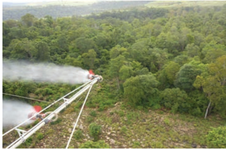
Rampe de traitement d'un hélicoptère lors d'un épandage de pesticides, Miandrivazo, février 2015.
