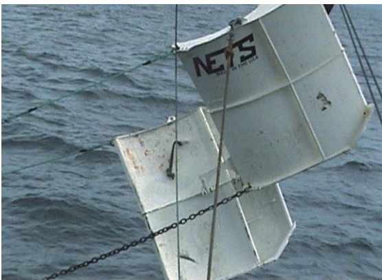
Figura 29. Portones hidrodinámicos utilizados en las redes prototipo.
