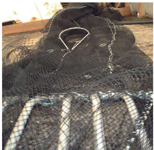
Figura 32. Ubicación del dispositivo excluidor de peces “Ojo de pescado” en el bolso de la red.
