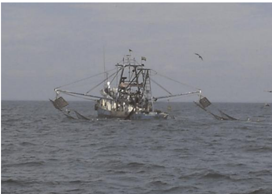
Figura 5. Sistema de pesca de arrastre con doble aparejo para la captura de camarón.
