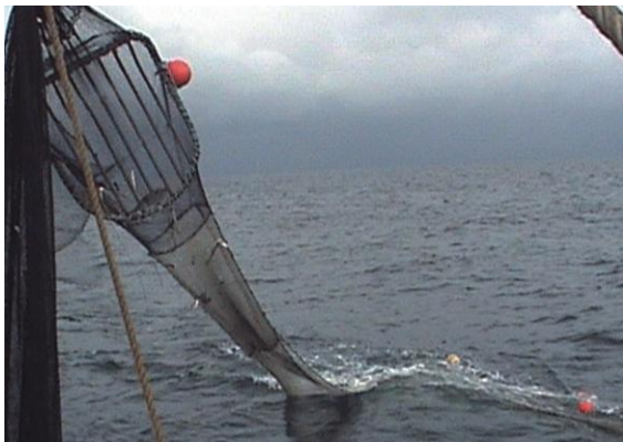
Figura 30. Dispositivo excluidor de tortugas (DET) utilizado en el Pacífico colombiano.
