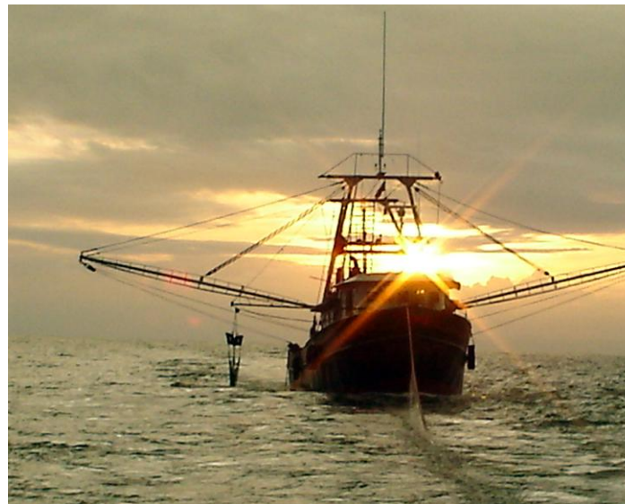
Figura 3. Embarcación tipo tangonera usala pesca de arrastre de camarón en el Pacífico colombiano.
