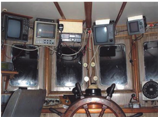
Figura 36. Equipo de medición y ecodetección en el puente usados para las mediciones técnicas durante los experimentos de pesca.
