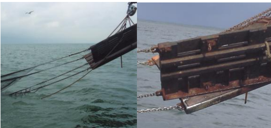
Figura 10. Apareamiento de las redes con las puertas de arrastre. El brillo de la zapata y de las extensiones de cadena en la relinga inferior muestra la fricción sobre el fondo.
