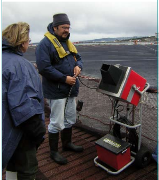
FIGURA 14 Utilización de cámara submarina para controlar el suministro de alimento (Chile)
