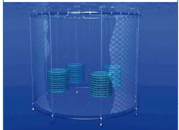
FIGURA 13 Ejemplo de jaulas adaptadas para peces planos
