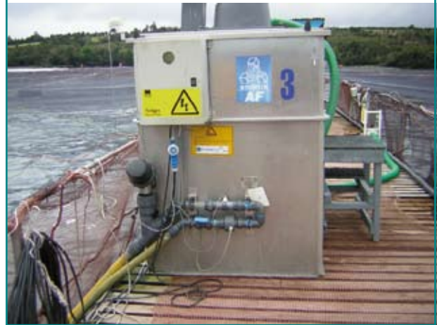
FIGURA 13 Silo de alimentación automática con sistema de recolección de alimento (Chile)
