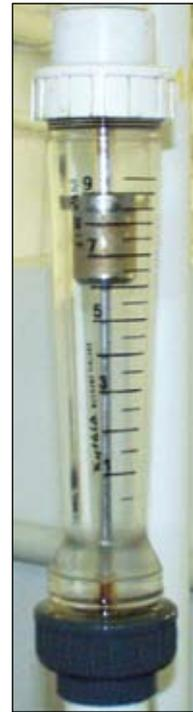
الشكل ٥-٩: جهاز قياس التدفق داخل الخط المستخدم في نظام التنقية
