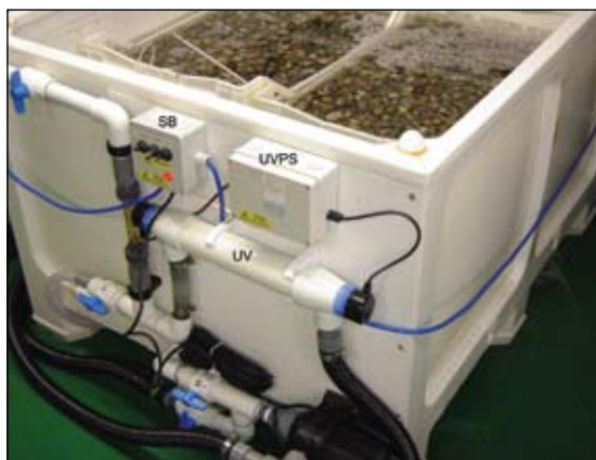
图6.3 小型浅槽系统中的紫外装置
