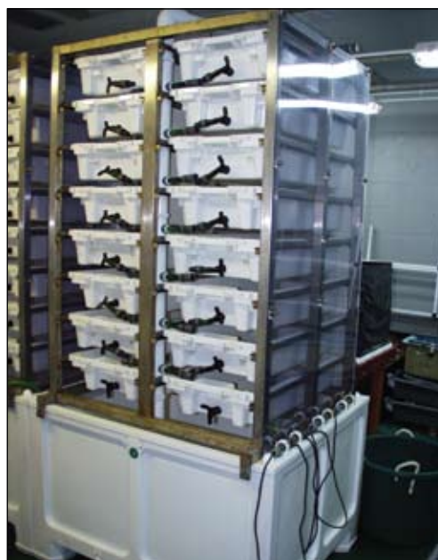
图5.5 垂直堆叠型净化池系统
