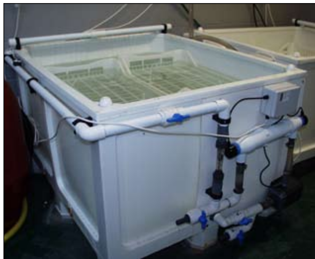
图5.4 小型的浅水净化池系统
