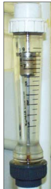
图5.9 净化系统中的转子流量计
