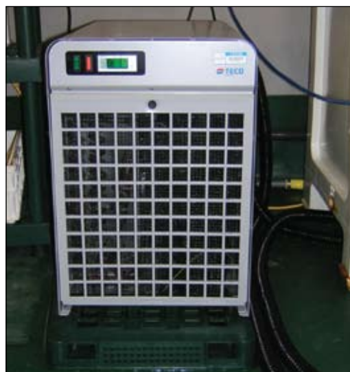
图5.10 与小型标准系统配套的加热/冷却装置
