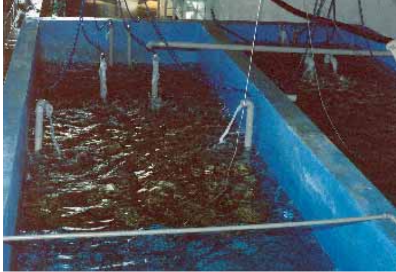
الشكل 13 ب مضخات الجسر الهوائي تحافظ على حركة الماء ودخول الأكسجين (بيرو)
